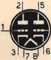
12SX7 DOPPIO TRIODO AMPL. B.F. (zoccolo octal)
