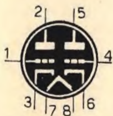
12SN7 DOPPIO TRIODO AMPL. B.F. (zoccolo octal)
