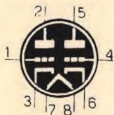
12SL7 DOPPIO TRIODO AMPL. B.F. (zoccolo octal)
