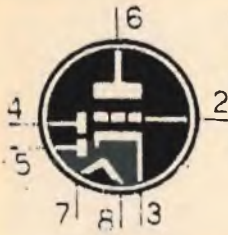
12SR7 DOPPIO DIODO TRIODO RIV. AMPL. B.F. (zoccolo octal)
