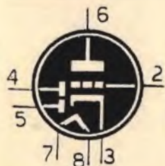
12SQ7 DOPPIO DIODO TRIODO RIV. AMPL. B.F. (zoccolo octal)
