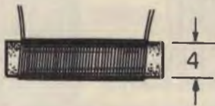
Fig. 5 - L'impedenza di alta frequenza J1 è avvolta su un supporto di materiale isolante del diametro di 4 mm. Il filo, ricoperto in cotone, ha un diametro di 0,6 mm; le spire, avvolte in forma compatta, sono in numero di 50.
