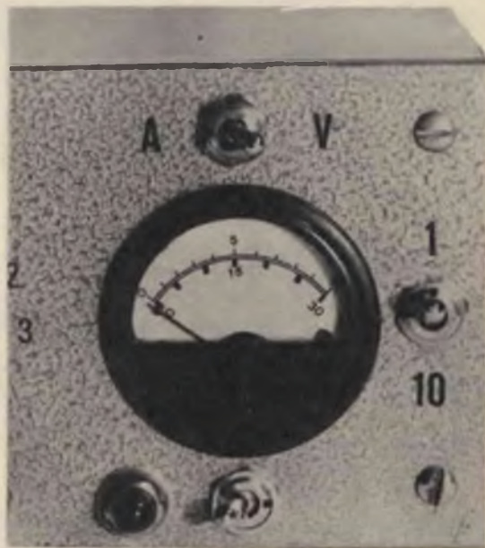
Fig. 3 - Particolare dell'alimentatore a basse tensioni. Lo strumento di misura è un milliamperometro dotato di scala suddivisa in trenta parti.
