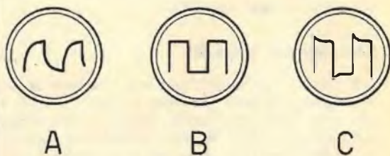
Fig. 7 - Tipi di figure che si possono vedere sullo schermo del tubo a raggi catodici nella prima fase del processo di taratura dello strumento.
