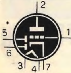
12EL6 DOPPIO DIODO TRIODO RIV. AMPL. BF (zoccolo miniatura)
