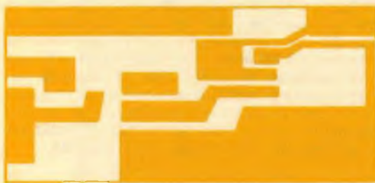
Fig. 4 - Per ottenere un cablaggio privo di fili conduttori, semplice e razionale, il lettore dovrà costruire il circuito stampato seguendo il disegno qui riprodotto.
