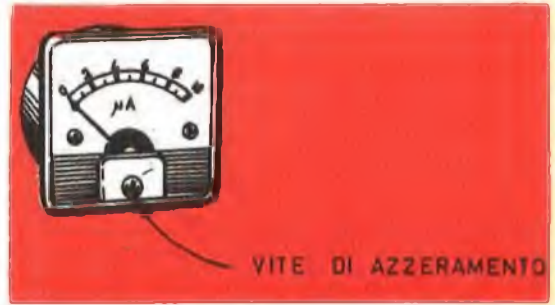
Fig. 1 - Tutti gli strumenti indicatori sono dotati di una scala graduata, di un indice mobile e di una vite di azzeramento. Essi possono presentarsi sotto forme e aspetti diversi, a seconda dell'uso cui sono destinati e della casa costruttrice.
