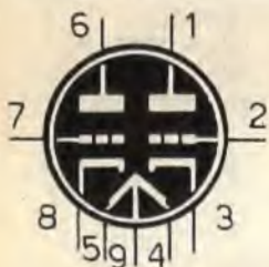
9AU7 DOPPIO TRIODO AMPL. A.F. (zoccolo noval)
