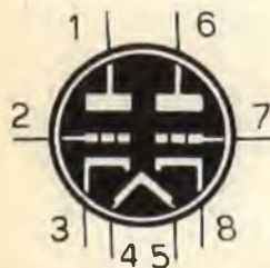
9BK7A DOPPIO TRIODO AMPL. A.F. (zoccolo noval)
