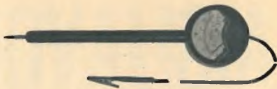
Fig. 5 - Esempio di voltmetro di tipo commerciale per la misura delle alte tensioni.
