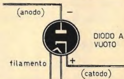
Fig. 2 - Simbolo elettrico e circuito di collegamento teorico di un diodo a vuoto.
