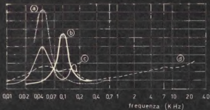
Fig. 2 - Questi diagrammi sono stati rilevati con l'impiego di più altoparlanti di tipo Philips EL 7021. In « a » è riprodotta la curva di risonanza di un altoparlante funzionante all'aria libera; in « b » è riprodotta la curva corrispondente al montaggio di un altoparlante in un mobile provvisto di una sola apertura; la curva « c » è ottenuta con l'aggiunta di un secondo altoparlante con bobina mobile non cortocircuitata; in « d » è riprodotta la curva ottenuta cortocircuitando la bobina mobile del secondo altoparlante.
