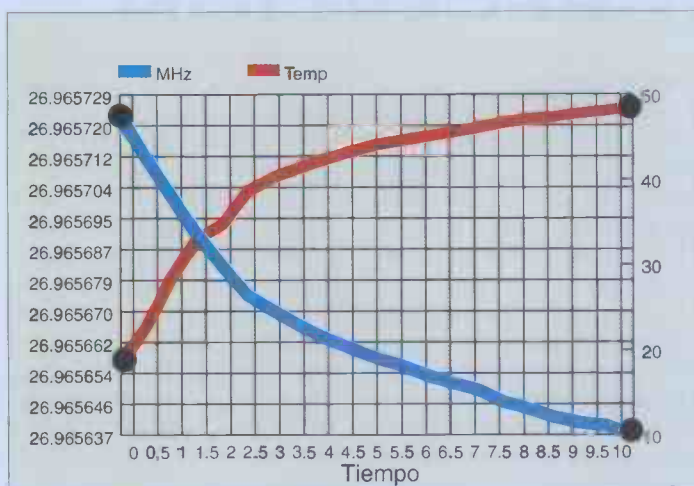
Gráfica de variación de la temperatura y la frecuencia en el tiempo. Los valores correspondientes pueden verse en el cuadro de la derecha.
