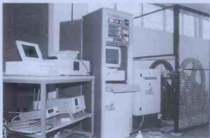
En la foto se puede ver el instrumental con el que Asinel realiza los ensayos de tracción para cables de fibra óptica.
