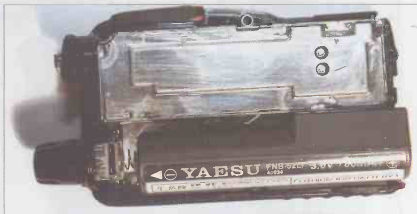
El VX-1R funciona con una batería de litio-ión, aunque también incluye la posibilidad de utilizar un adaptador y una pila alcalina de 1,5 voltios.
