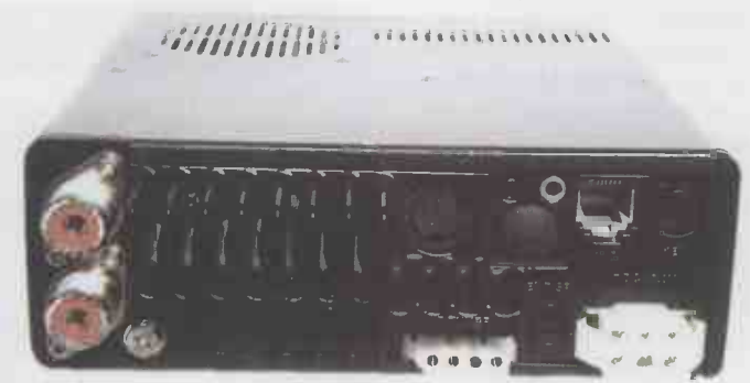
Vista de la parte posterior en la que se pueden apreciar las dos salidas de antena (dependiendo de la banda sintonizada), el jack para RTTY, la toma de alimentación y el radiador de refrigeración.
