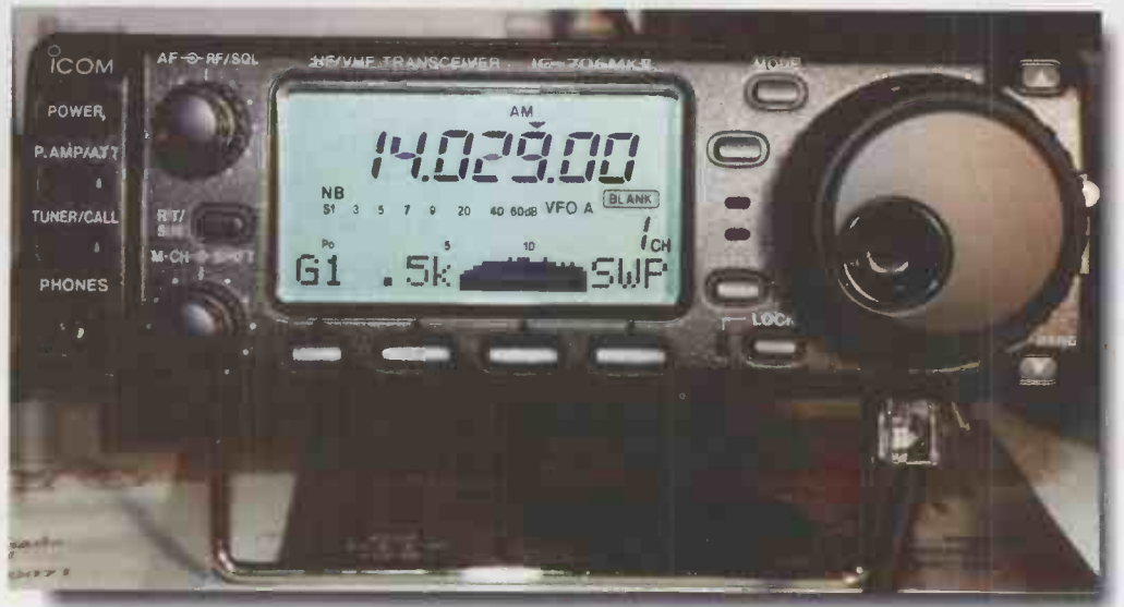
Su analizador de espectros es capaz de visualizar un margen de frecuencias próximas a la sintonizada, siendo posible utilizar un ajuste de 100 KHz además de los que ya disponía en su versión anterior.
