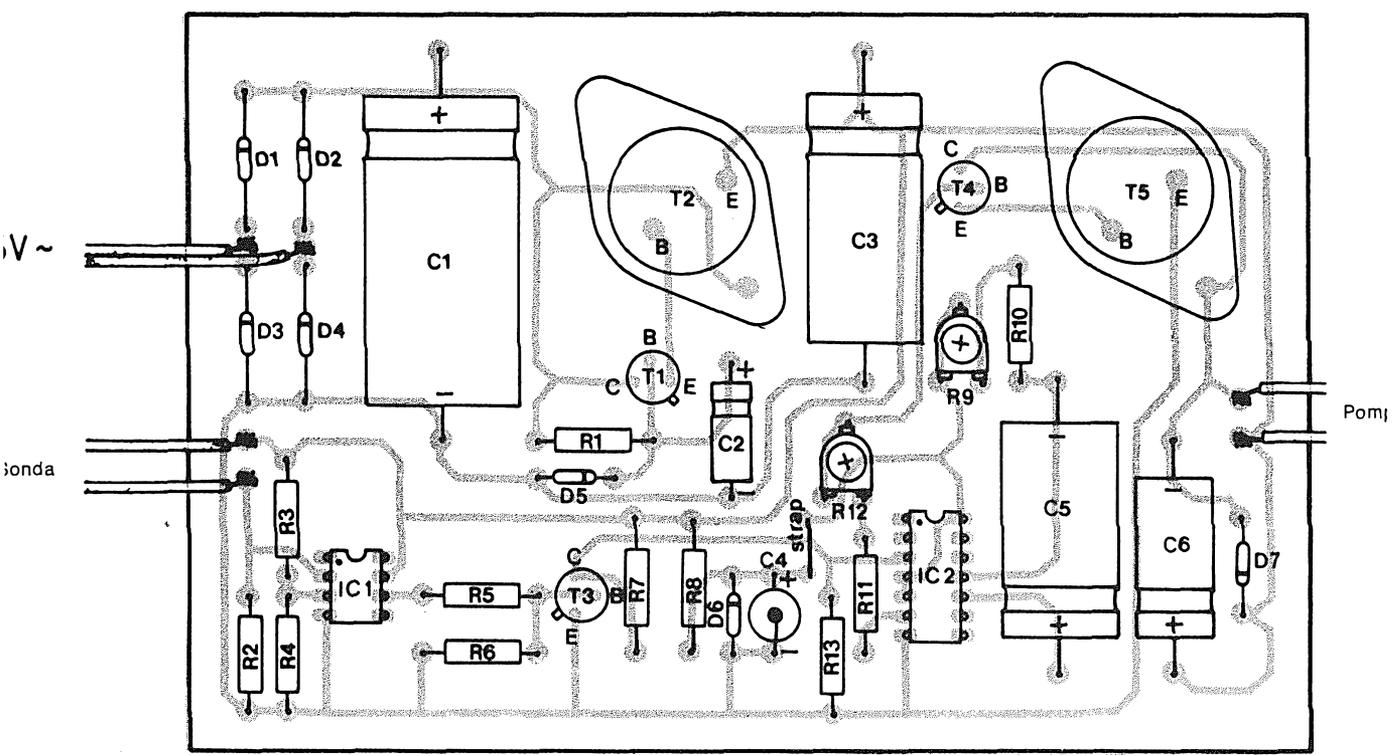
▶ trimmer a metà corsa. Non c'è da temere che i transistor scaldino. Per installare il dispositivo sul vaso si conficca la sonda, montata in un pezzo di resina epossidica, lasciandola sporgere di un centimetro sopra il livello della terra
