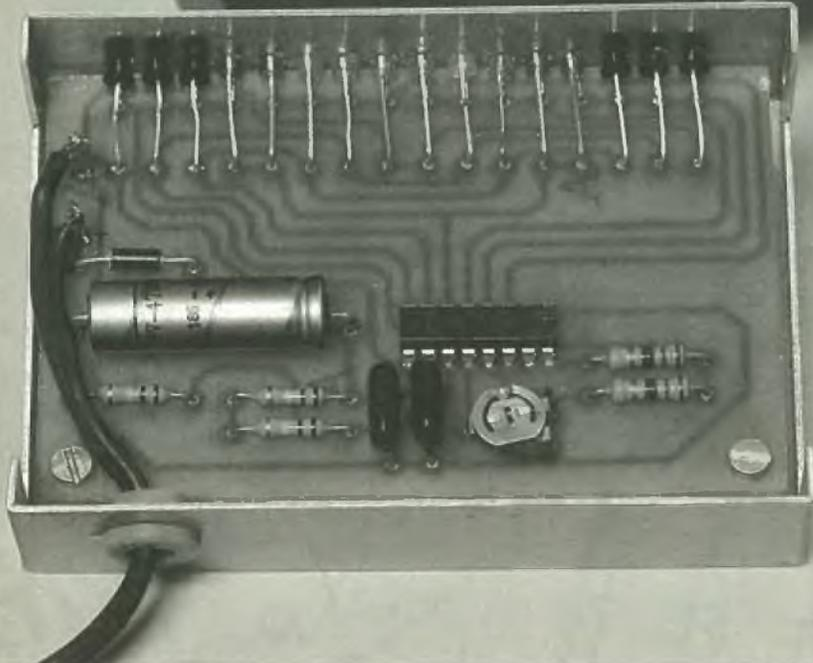
La fig. 1 permette di rilevare la estrema semplicità dell'apparecchio. Essa è dovuta soprattutto all'impiego di un integrato particolarmente adatto a questo scopo (UAA 170). Viene alimentato un Led, uno solo per volta in una fila di 16. Osserviamo che il corrispondente UAA 180 permette di accendere contemporaneamente tutti i LED, come un termometro. Abbiamo però preferito la prima soluzione perché non disturba troppo l'attenzione del guidatore, soprattutto di notte.
