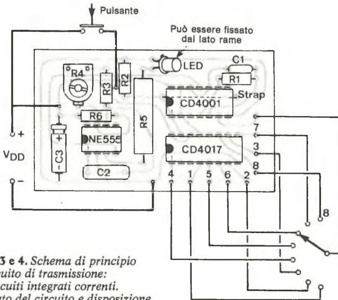
**Figura 3 e 4.** Schema di principio del circuito di trasmissione: solo circuiti integrati correnti. Tracciato del circuito e disposizione dei componenti in grandezza naturale. Attenzione al ponticello sotto il CD4001.
