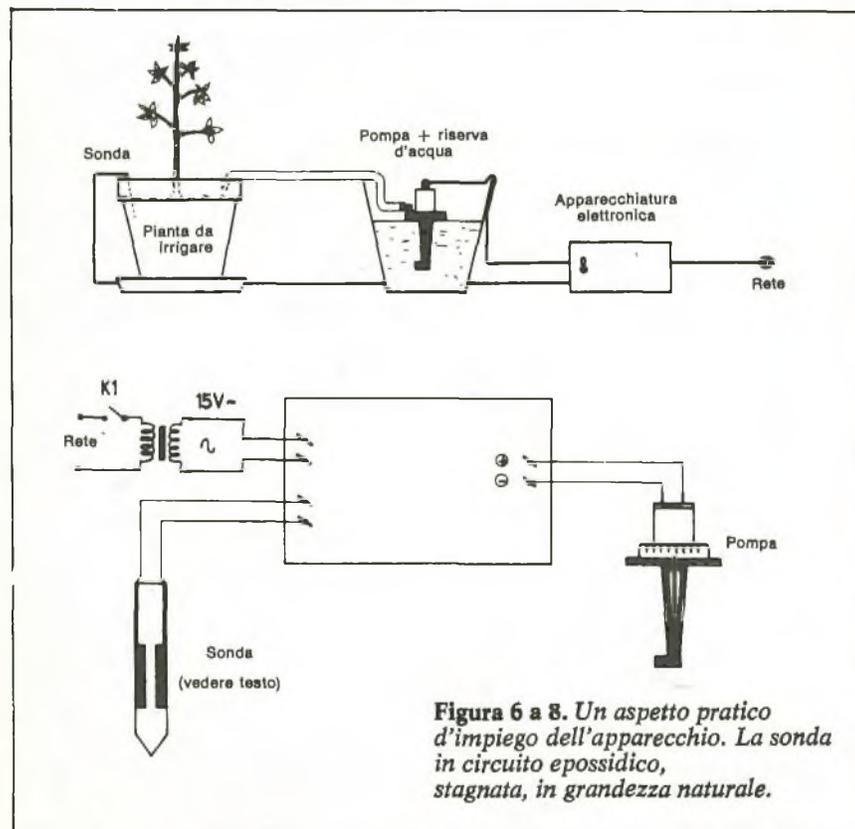
Figura 6 a 8. Un aspetto pratico d'impiego dell'apparecchio. La sonda in circuito epossidico, stagnata, in grandezza naturale.
