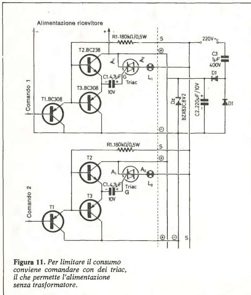
Figura 11. Per limitare il consumo conviene comandare con dei triac, il che permette l'alimentazione senza trasformatore.
