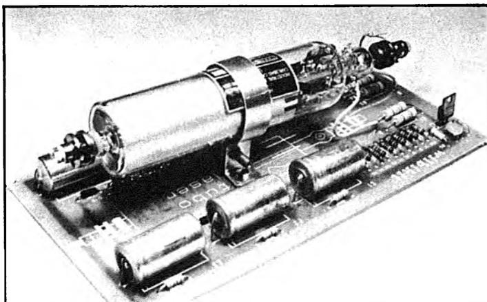
Costruisci un generatore laser da 5 mW di potenza. Una scatola di montaggio per preparare un laser a luce rossa adatta per esperimenti scientifici ed effetti psichedelici. La confezione comprende il circuito stampato inciso e serigrafato; i componenti necessari al montaggio ed il tubo laser da applicare direttamente sulla basetta. Il kit è reperibile presso i distributori dei nostri prodotti oppure direttamente per corrispondenza.
