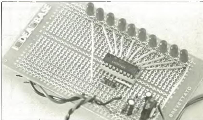
tinua che alternata, che provenendo dai circuiti di amplificazione raggiunge il nostro integrato. Unitamente a  $C_1$  e a  $C_2$  costituiscono poi un efficace filtro passa basso che permette di far passare solo i segnali inferiori a pochi Hz, e quindi rendono sensibile il circuito alla continua e ai « toc » improvvisi, e nello stesso tempo insensibile al
