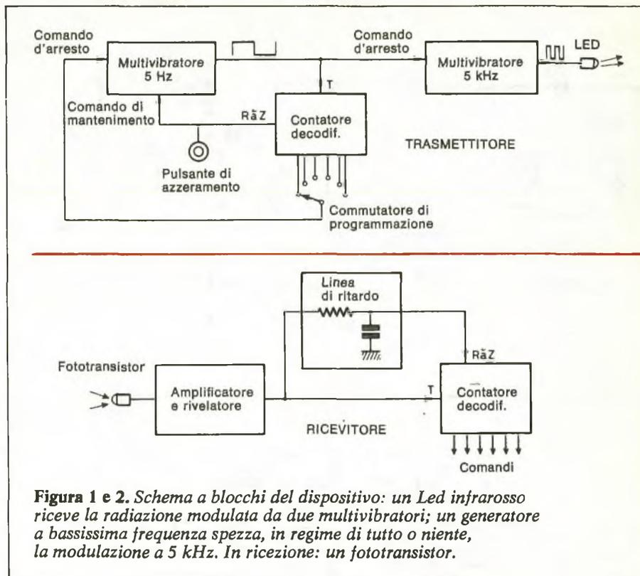
Figura 1 e 2. Schema a blocchi del dispositivo: un Led infrarosso riceve la radiazione modulata da due multivibratori; un generatore a bassissima frequenza spezza, in regime di tutto o niente, la modulazione a 5 kHz. In ricezione: un fototransistor.
