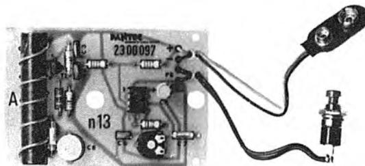
**TRASMETTITORE E RICEVITORE PER RADIOCOMANDO**
