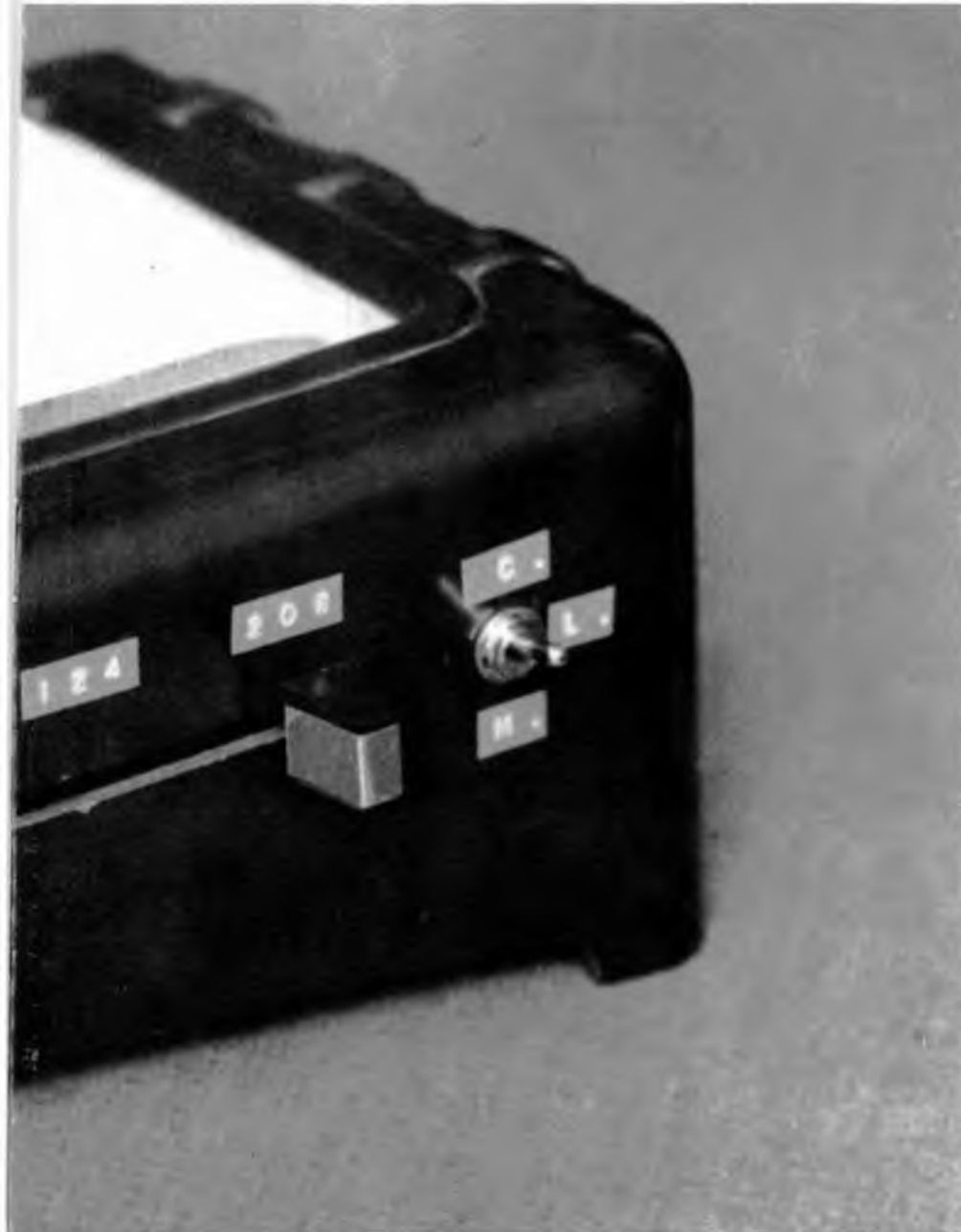
Il prototipo realizzato dall'autore: utilizza il micrologico 555. Alimentazione in continua e amplificazione a transistor in altoparlante.
