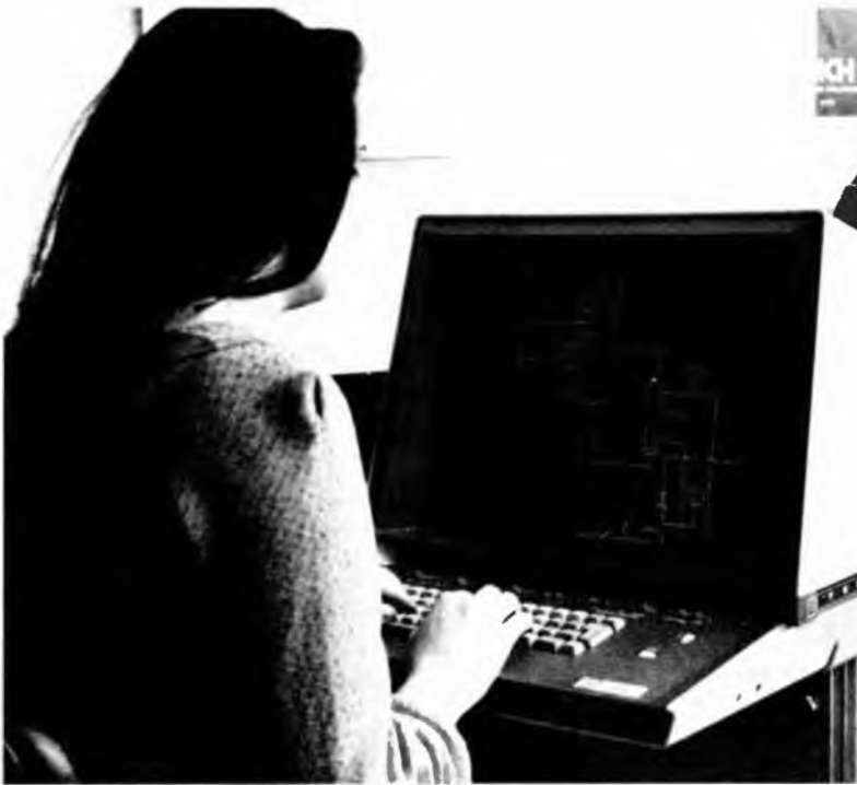
Particolare di uno schema elettrico in corso di elaborazione, visualizzato sullo schermo di un terminale videografico abbinato ad un calcolatore elettronico. (Datamont Graphic Editor). In alto, nella pagina accanto, unità a nastri magnetici IBM.
