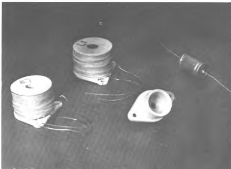
In alto il diffusore acustico a montaggio ultimato; sotto, induttanze e capacità necessarie per la realizzazione del filtro cross-over che separa le frequenze audio secondo due canalizzazioni per consentire agli altoparlanti di lavorare al massimo rendimento.
