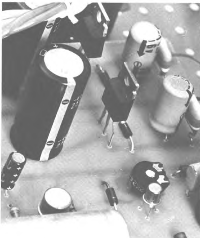
I regolatori di tensione che provvedono a dimensionare la tensione di alimentazione secondo le esigenze circuitali si avvalgono del proprio dissipatore mentre TR3, il transistor di potenza che assicura la corrente necessaria, è fissato su di un'aletta di raffreddamento.
