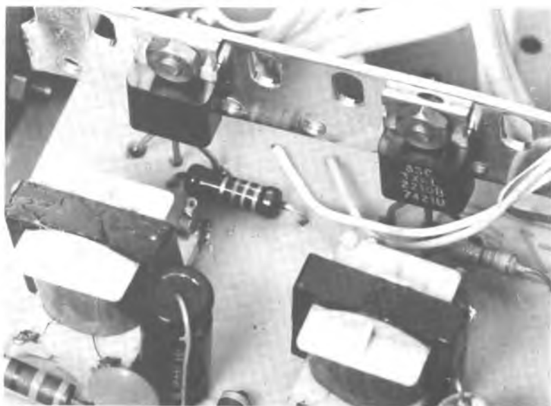
Schema logico delle connessioni fra le varie parti (in alto). Sotto, particolare del fissaggio dei triac alla barretta di metallo usata come dissipatore.
