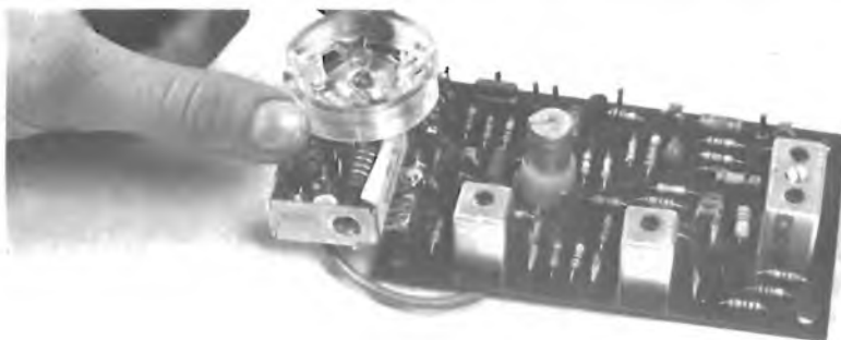
Il preamplificatore può essere collegato alla presa di antenna del ricevitore commerciale, oppure, nel caso degli autocostruiti, inglobato nella struttura medesima.
