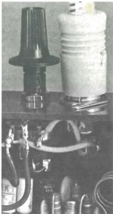
I collegamenti al potenziometro fornito di interruttore e alla presa per lo spinotto del microfono.
