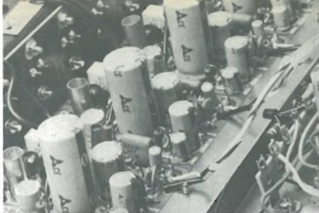
Particolare di una delle basette. Sul corpo di ogni transistor è stato infilato un dissipatore termico di forma cilindrica.
