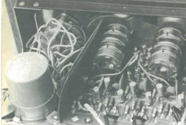
Come si vede dall'immagine, i potenziometri per la regolazione fisiologica sono quadrupli. Questo consente di sistemare contemporaneamente i quattro canali.
