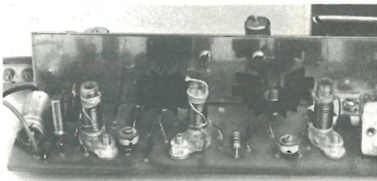
Gli elementi più critici da realizzare sono le bobine oscillanti. Perché il loro rendimento non subisca diminuzioni consigliamo di fare uso di supporti in materiale adatto per le alte frequenze.
