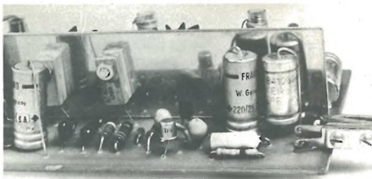
Particolare del modulatore. Per una migliore dissipazione termica i transistor finali BF sono saldamente vincolati allo schermo in metallo che opera anche da raffreddatore.
