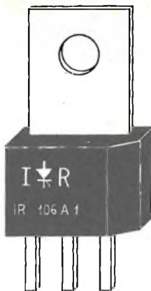
Catodo Anodo Porta o Gate Disposizione dei terminali degli SCR impiegati.
