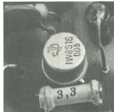
Particolare del prototipo costruito con basetta in vetronite per eliminare perdite di radiofrequenza.
