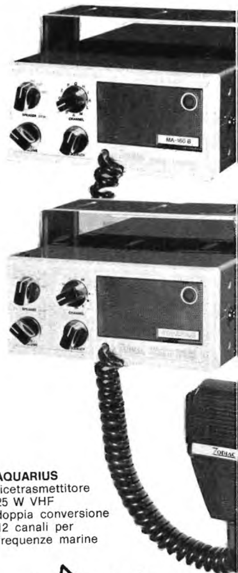
MA-160B ricetrasmittitore VHF 25 W in banda privata
