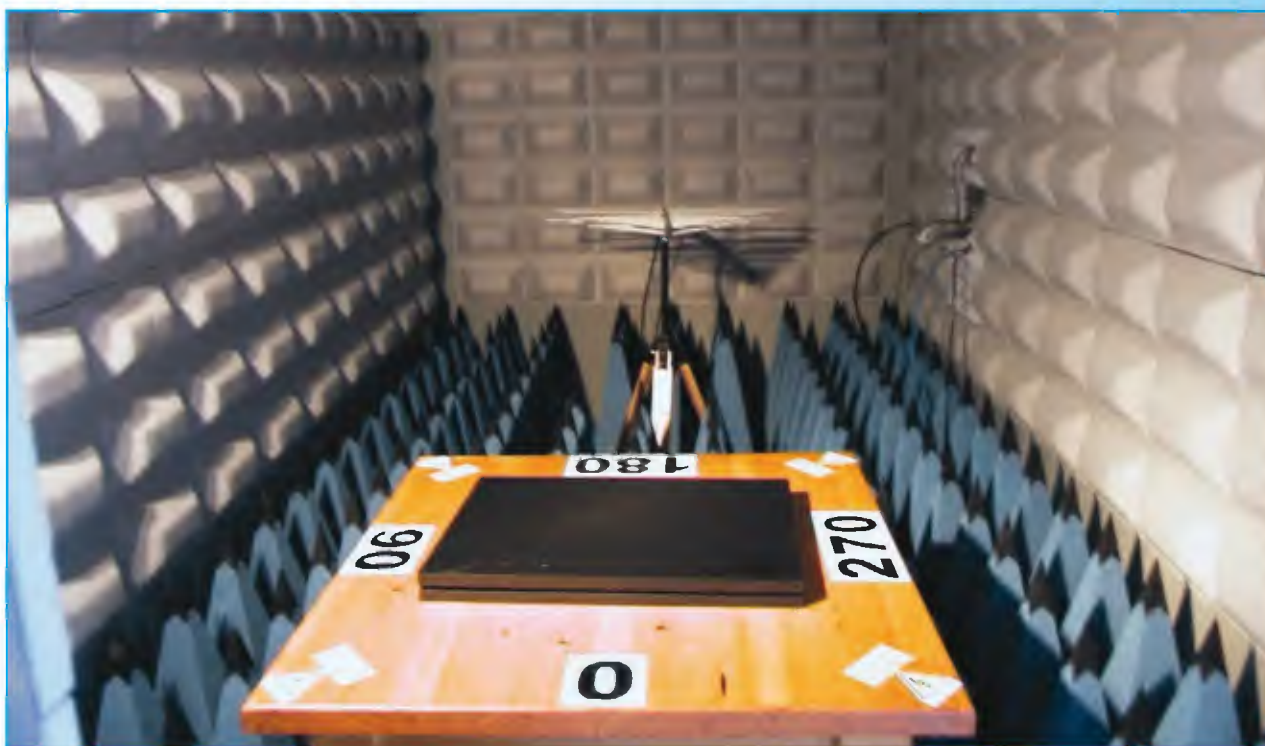
Fig.2 - Camera schermata con antenna di misura e banco supporto elettroniche.
