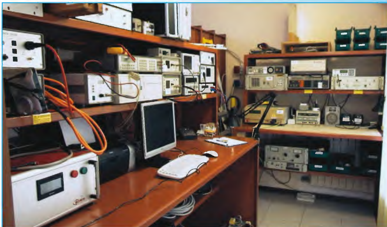
Fig.1 - Banco di lavoro misure radioelettriche.
