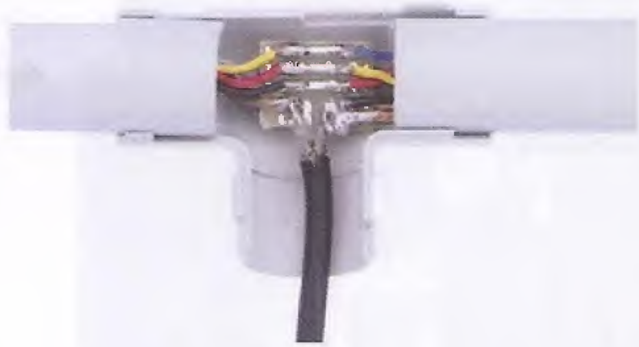
Fig.16 Se vi interessa cercare oggetti metallici di dimensioni ridotte, realizzate una bobina captatrice arrotolando il cavo multifilo in una matassa. In alto, la foto evidenzia il punto di cablaggio della bobina.
