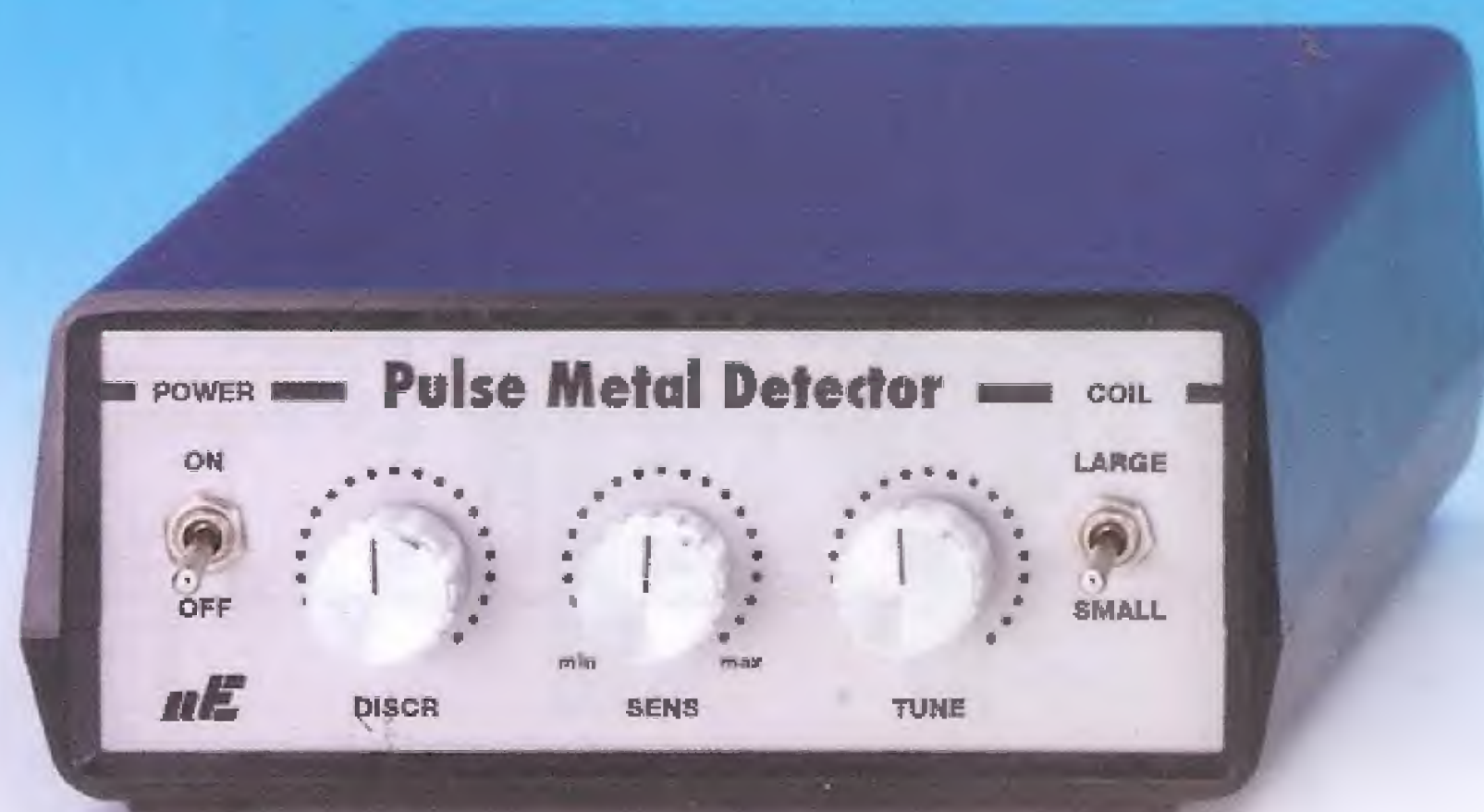
Fig.12 Foto del mobile plastico MO1765 che abbiamo utilizzato per accogliere il circuito del cercametalli LX.1765 e dell'alimentatore LX.1766.
