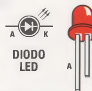
Schema elettrico del lampeggiatore e, sotto, connessioni dell'integrato 4093, del transistor BC337 e del diodo led utilizzati nel circuito.
