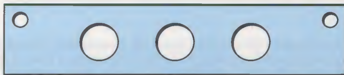
Fig.8 Il piccolo circuito stampato provvisto di 3 larghi fori andrà fissato sul circuito principale utilizzando due distanziatori metallici, come visibile in fig.10.
