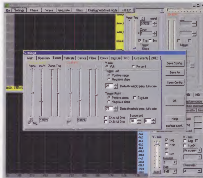
Fig.20 Cliccate sul tasto Settings posto nella parte alta a sinistra dello schermo. All'interno della finestra che si aprirà selezionate l'opzione Scope e nella finestra successiva
