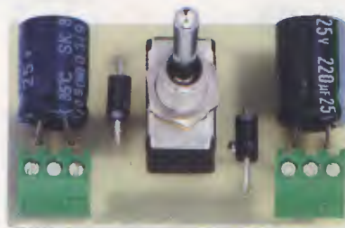
Fig.3 Foto del circuito stampato come si presenta a montaggio ultimato. Come potete vedere in fig.4, il circuito stampato andrà fissato nel contenitore plastico tramite il dado del deviatore S1.
