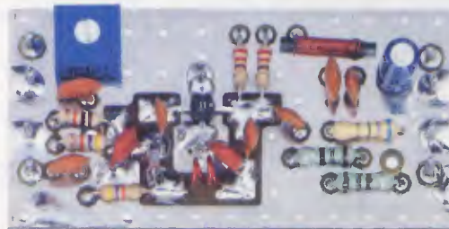
Fig.8 In questa foto potete vedere l'oscillatore VHF come si presenta a montaggio ultimato. Per realizzare la bobina L1 consultate la Tabella N.2.
