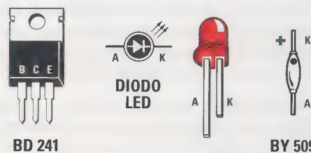
Fig.3 Connessioni del transistor BD.241. Per individuare il terminale + dei diodi ad alta tensione da DS1 a DS10 vedi la fig.4 . Il terminale K di DL1 è quello più corto.
