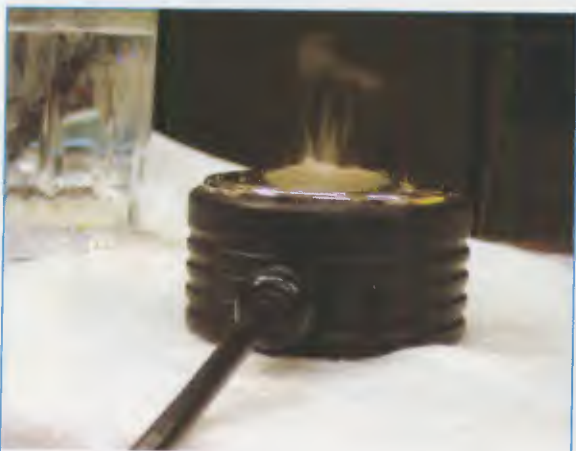
Fig.1 Nel generatore di ultrasuoni ad 1 MHz ponendo una goccia d'acqua sulla superficie del trasduttore si ottiene un evidente effetto di vaporizzazione.
