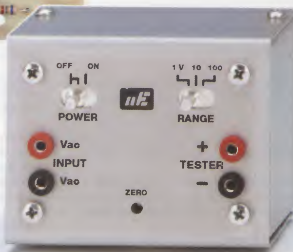
Fig.10 Foto del montaggio di uno dei nostri primi esemplari sottoposto a collaudo. Eseguito il collaudo, abbiamo modificato il circuito spostando solo la posizione della resistenza R1.
