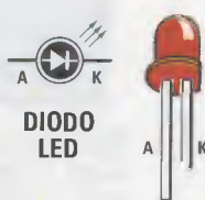
Fig.5 Le connessioni dell'integrato stabilizzatore MC.78L05 e del transistor metallico 2N2222 viste da sotto. L'Anodo (A) è il terminale più lungo del diodo led e va collegato al +.
