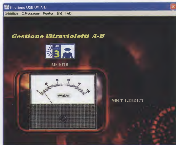
Fig.28 Inizieranno a giungere i dati rilevati dal sensore. In particolare sopra lo strumento virtuale apparirà l'equivalente binario del segnale che emette il sensore UVA/B e, a lato, la tensione in Volt rilevata in tempo reale.
