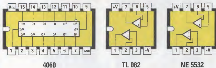
Fig.11 Le connessioni degli integrati utilizzati in questo progetto sono viste da sopra e con la tacca di riferimento a U rivolta a sinistra.
