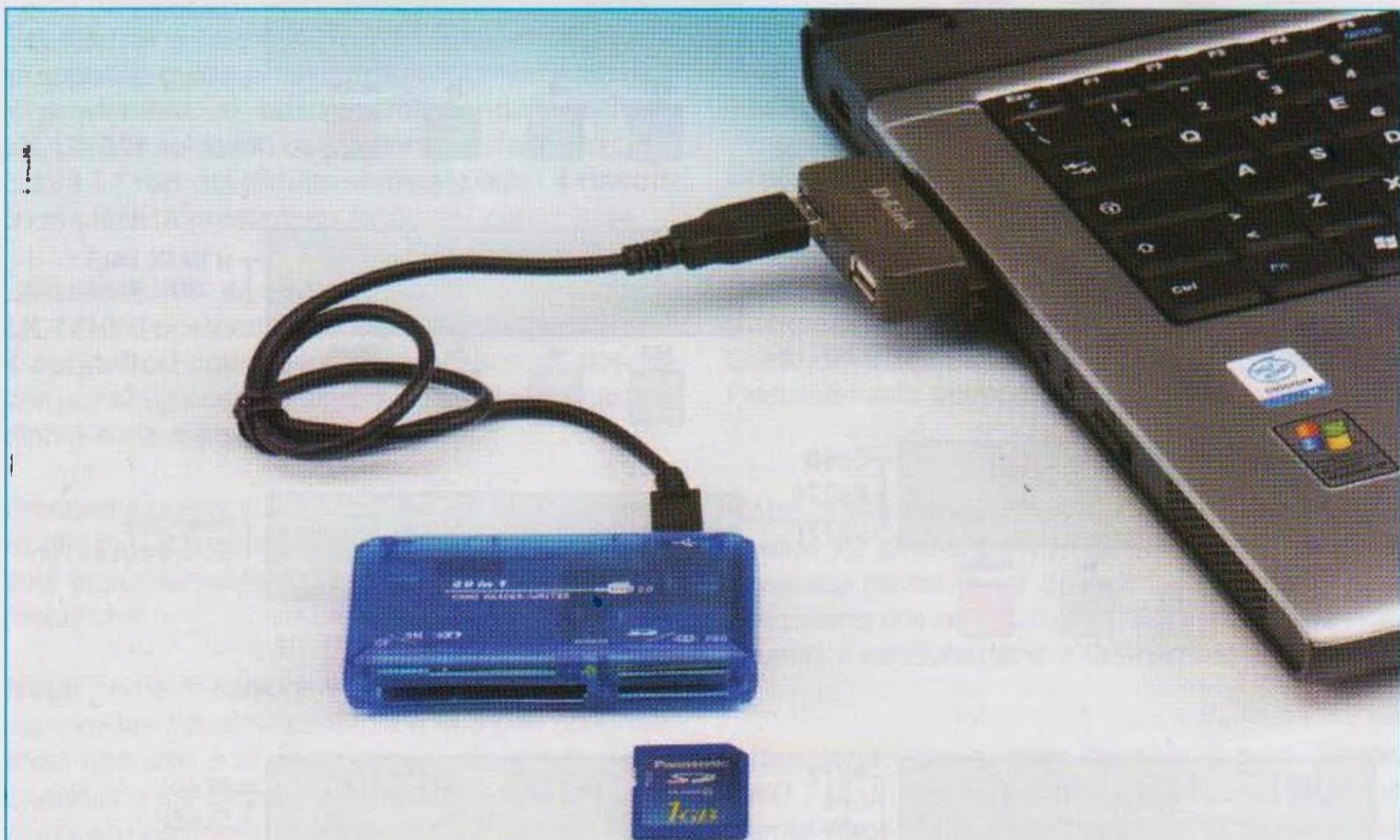
Fig.28 Per estrarre i dati raccolti nella SD card dovrete inserirla in un Card reader che andrà collegato alla porta USB del computer. I dati sono memorizzati all'interno del file GeigerNE.txt e possono facilmente essere importati all'interno di un foglio Excel, per elaborare grafici e statistiche.
