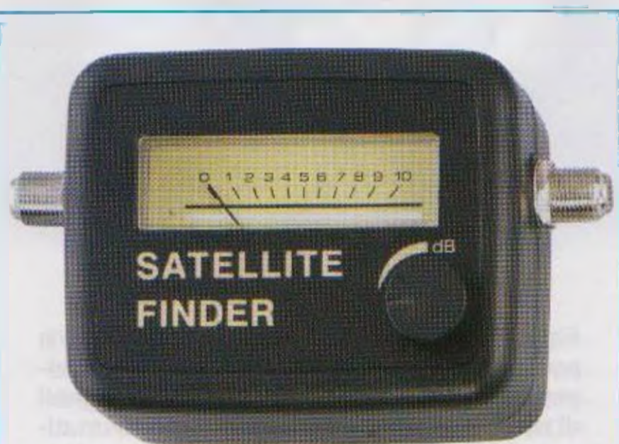
Fig.1 Foto del Satellite Finder visto frontalmente. Nel connettore a F posto a destra va collegato il connettore maschio del cavo coassiale proveniente dallo stadio di alimentazione, mentre nel connettore a F posto a sinistra va collegato il connettore maschio del cavo coassiale da collegare al convertitore LNB (vedi fig.3 ).
