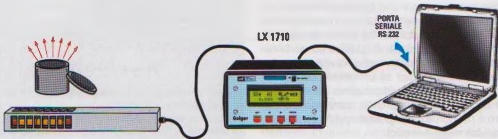
Fig.4 Il contatore è predisposto anche per essere collegato via RS232 ad un personal computer. In questo modo i valori della radioattività misurati dal contatore verranno automaticamente aggiornati ogni 10 secondi sul video del computer, consentendo di osservare in tempo reale come varia l'intensità di qualunque fenomeno radioattivo. I dati raccolti potranno poi essere memorizzati sull'hard disk del pc.
