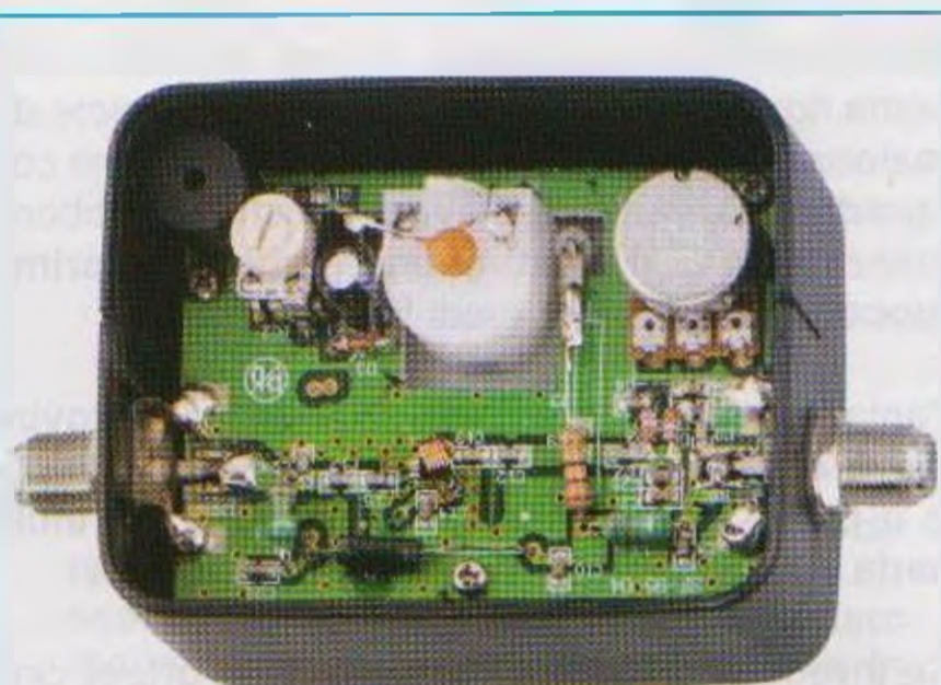
Fig.2 All'interno del Satellite Finder è inserito un amplificatore che amplifica tutti i segnali TV di circa 11 dB . Sul coperchio di questo amplificatore sono riportate vicino al connettore a F di destra la scritta " TO REC ", mentre vicino al connettore a F di sinistra la scritta " TO LNB ", da collegare al convertitore LNB (vedi fig.3 ).
