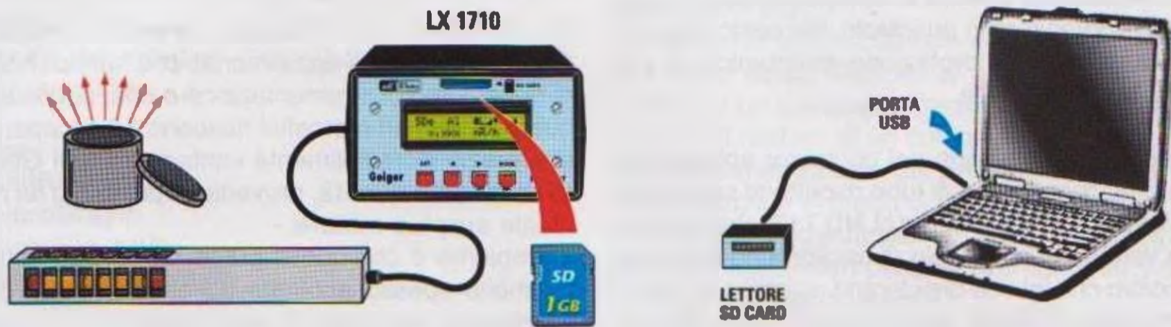
Fig.3 Inserendo nel contatore una SD card da 1 Gbyte avrete la possibilità di registrare un numero enorme di dati, eseguendo rilevamenti accurati della radioattività ambientale su un arco anche molto prolungato di tempo. I dati raccolti potranno essere successivamente elaborati tramite un personal computer, inserendo la SD card nell'apposito Card reader, collegato alla porta USB del pc.
