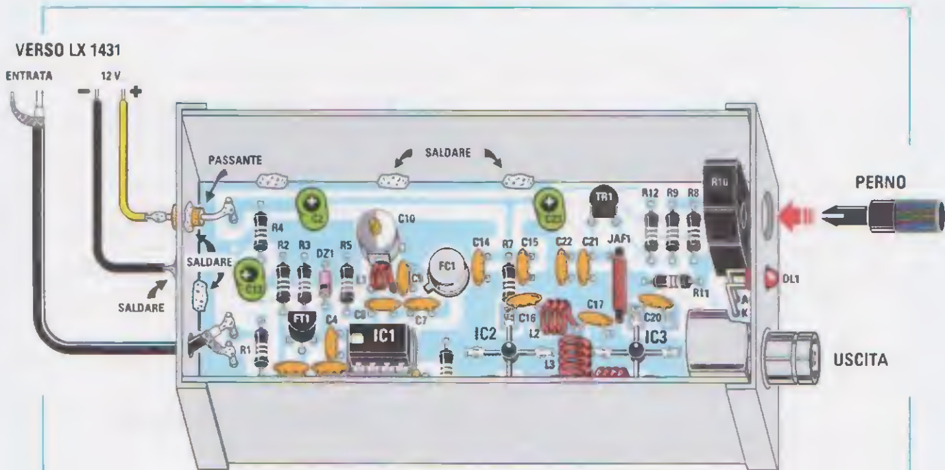
Fig.8 Il generatore tracking va collocato nel mobile di lamiera che vi forniamo già forato e che ha il compito di schermare il circuito dai disturbi esterni. Per questo motivo lo stampato va saldato direttamente al mobile. Per il ramo positivo dell'alimentazione si è utilizzato un passante, mentre il negativo è derivato direttamente dal contenitore.
