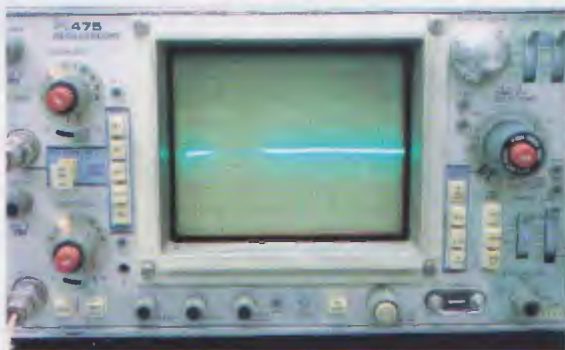
Fig.16 Dopo aver ruotato il trimmer R10 in senso orario per avere in uscita la massima potenza, girate la vite del compensatore C10 fino a visualizzare un segnale come questo.
