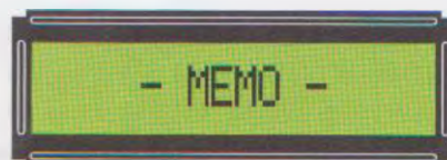
Fig.30 Per memorizzare la frequenza visualizzata sul display, tenete premuto il tasto di conferma # fino a quando non compare la scritta MEMO .
