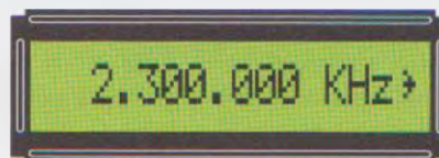
Fig.27 Non appena alimentate il Generatore UHF, vedete subito apparire sul Display il numero 2.300.000 KHz . A questo punto potete digitare la frequenza che vi serve.
