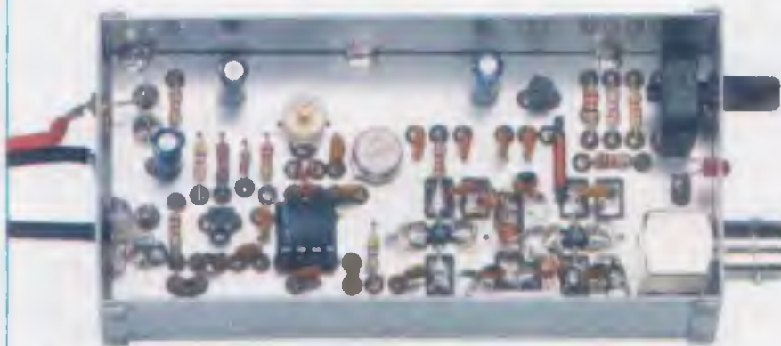
Fig.9 Come si presenta il generatore collocato all'interno del contenitore in lamiera.
