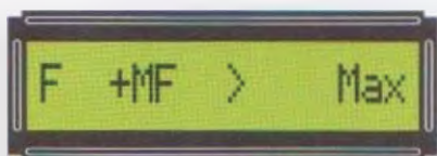
Fig.39 Se sul display appare F+MF > Max, significa che avete superato la frequenza massima di 2.800.000 KHz che questo Generatore è in grado di fornire.
