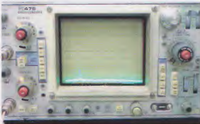
Fig.15 In realtà il compensatore C10 potrebbe risultare già tarato. Se così non fosse, sullo schermo dell'oscilloscopio non apparirà il segnale, ma solo del rumore.
