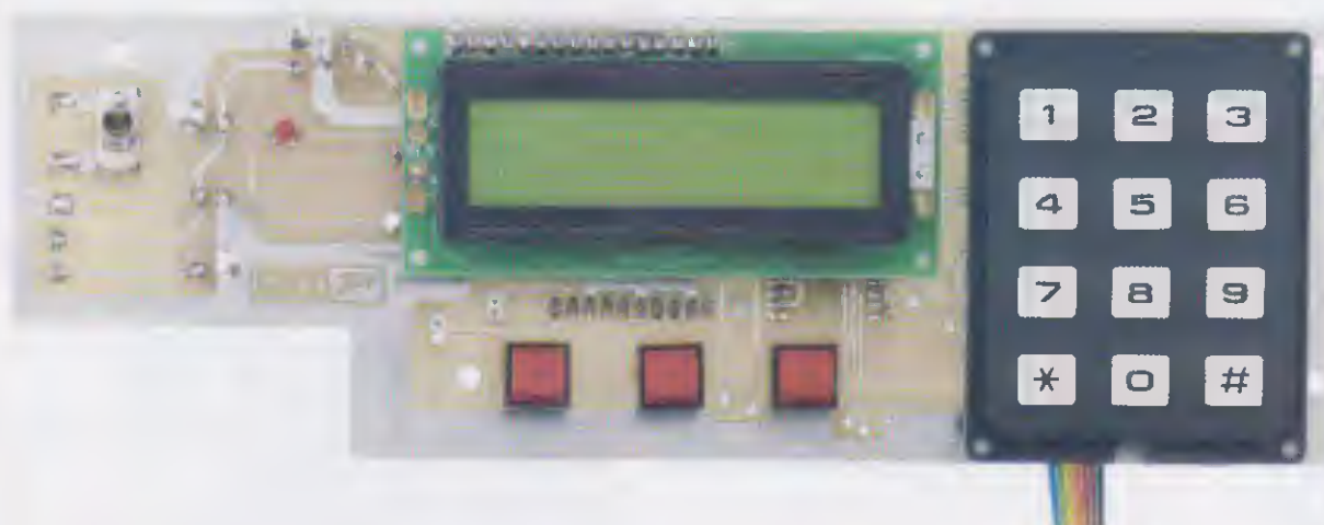
Fig.13 Come si presenta il circuito stampato LX.1700 dopo che avrete fissato il Display LCD a matrice e la Tastiera numerica. Se constatate che i perni dei distanziatori plastici entrano con difficoltà nei fori presenti sulla basetta del Display e sul corpo della Tastiera, non limateli, ma riscaldateli leggermente con la punta del saldatore.
