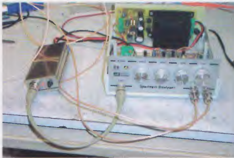
Fig.14 Per tarare il compensatore C10 collegate, con un cavo coassiale completo di BNC, il generatore all'analizzatore e quest'ultimo agli ingressi X-Y dell'oscilloscopio.
