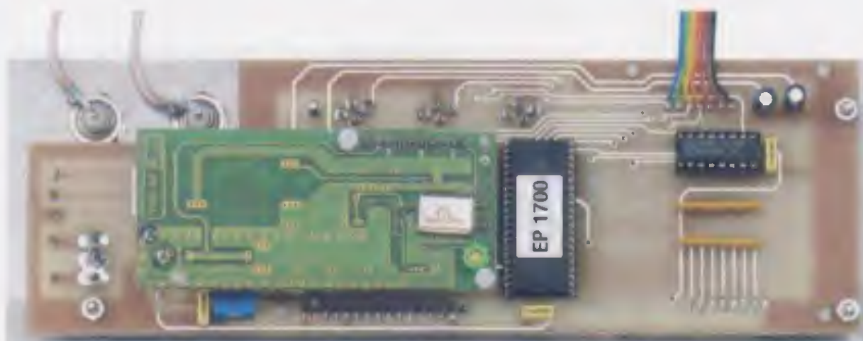
Fig.18 Prima di fissare sul circuito stampato LX.1700 la scheda siglata KM1644, vi consigliamo di innestare sul connettore maschio a 10 terminali il connettore femmina, quindi inserire i loro terminali sul circuito stampato base LX.1700 e solo dopo potrete saldarli. Seguendo questo procedimento di montaggio, avrete la certezza che la lunghezza dei terminali del connettore femmina sarà quella giusta per poter innestare la scheda KM1644 sul circuito stampato LX.1700 (vedi fig.19).
