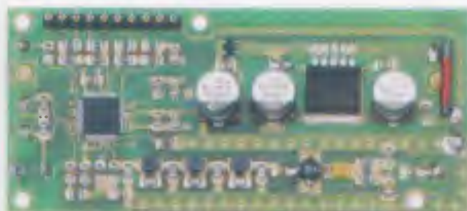
Fig.15 Come si presenta il circuito stampato LX.1700 dopo che lo avrete fissato stabilmente sulla mascherina frontale (vedi la foto in fig.24). Il trimmer quadrato a sinistra del Display serve per regolare la sua luminosità secondo le vostre preferenze.
