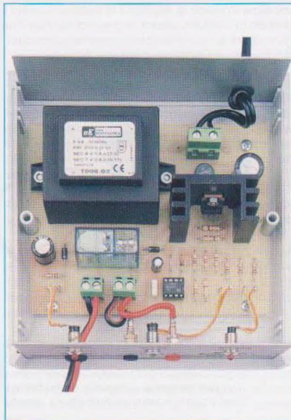
Fig.1 Per tenere accesa una lampadina da 12 Volt per un paio d'ore, potete utilizzare una piccola batteria da 1,2 Ah. Sotto, come si presenta il circuito stampato a montaggio ultimato ed inserito nel mobile plastico ad esso destinato.
