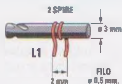
Fig.4 Per costruire la bobina L1 avvolgete 2 spire di filo di rame da 0,5 mm su un supporto da 3 mm di diametro. Spaziate le spire per avere un solenoide lungo 2 mm.
