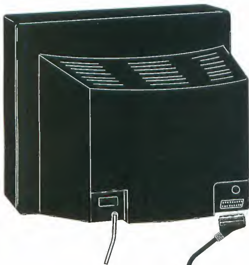
Fig.10 Se non avete o non volete acquistare uno dei tanti cavetti standard che si trovano in commercio per collegare il nostro circuito alla presa scart del televisore, potete realizzarne uno voi. A questo scopo vi serve una presa scart, del filo schermato ed uno spinotto RCA. Per questa applicazione collegate sul terminale 17 della scart la calza del filo schermato e sul terminale 19 il filo del segnale. In alto le connessioni delle prese scart.
