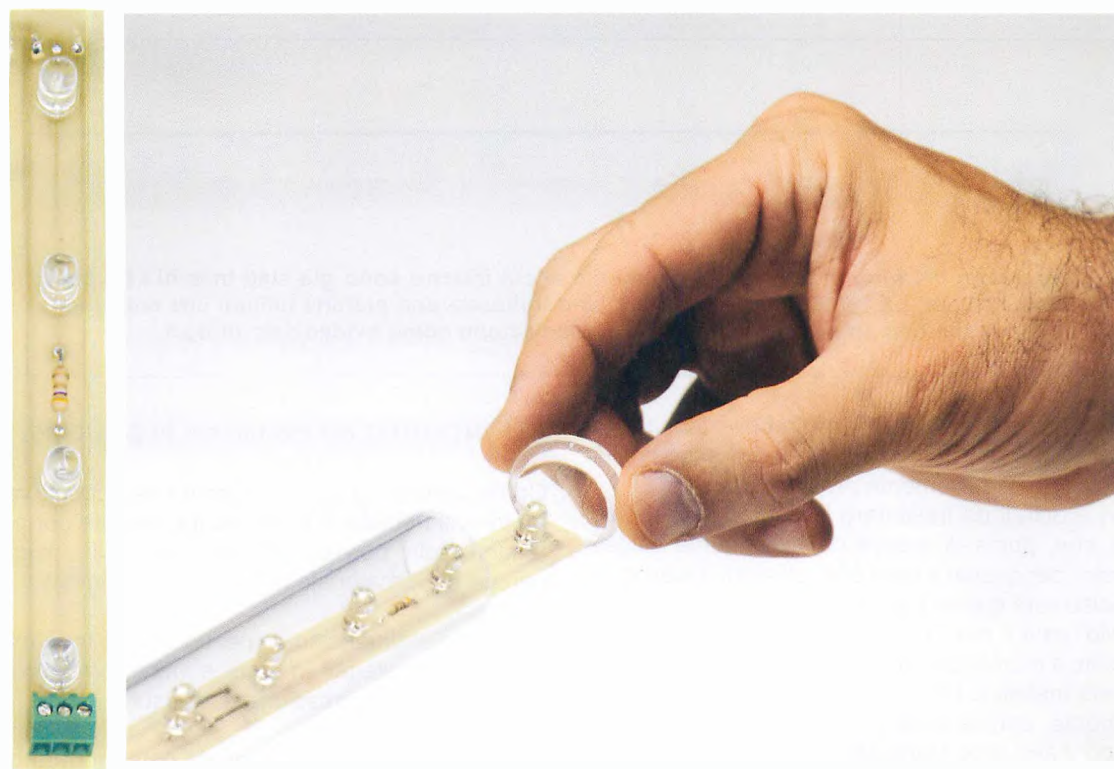
Fig.8 Foto di uno dei circuiti stampati LX.1689/B con già montati i diodi led. L'unico accorgimento che dovete usare è di saldare i diodi led a non più di 5 mm dallo stampato, altrimenti non riuscirete ad inserirli nel tubo in plexiglas. Questo tubo, molto leggero ed infrangibile, è fornito completo di due tappi di chiusura già forati per passare con il filo dell'alimentazione e con un incavo per bloccare gli stampati all'interno del tubo.
