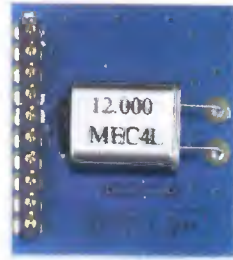
Fig.14 In alto, foto del montaggio dell'interfaccia LX.1690 e, qui sopra, foto del piccolo circuitino KM1667, visto da entrambi i lati, che vi forniamo già montato essendo realizzato con componenti in SMD.
