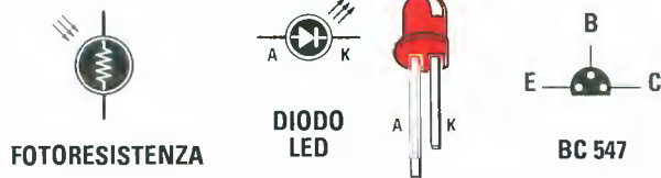
Fig.5 Simbolo elettrico della Fotoresistenza. Connessioni, del diodo Led e del transistor BC.547 viste da sotto. Nel montaggio rispettate la polarità A-K dei due terminali del diodo led.
