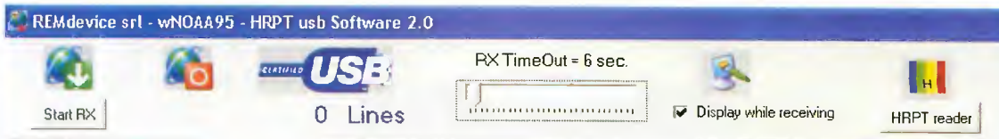
Fig.17 In questa figura abbiamo riprodotto la barra degli strumenti del software applicativo wNoaa95 per trasferire e visualizzare su computer i segnali in HRPT trasmessi dai satelliti polari. Nel testo abbiamo ampiamente descritto la funzione di ogni comando.
