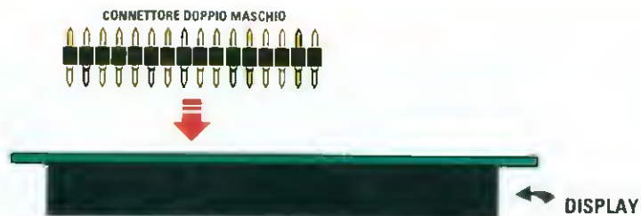
Fig.20 Prima di fissare il display sul circuito stampato LX.1661 dovete innestare nei fori predisposti sul suo supporto il doppio connettore maschio che troverete nel blister.
