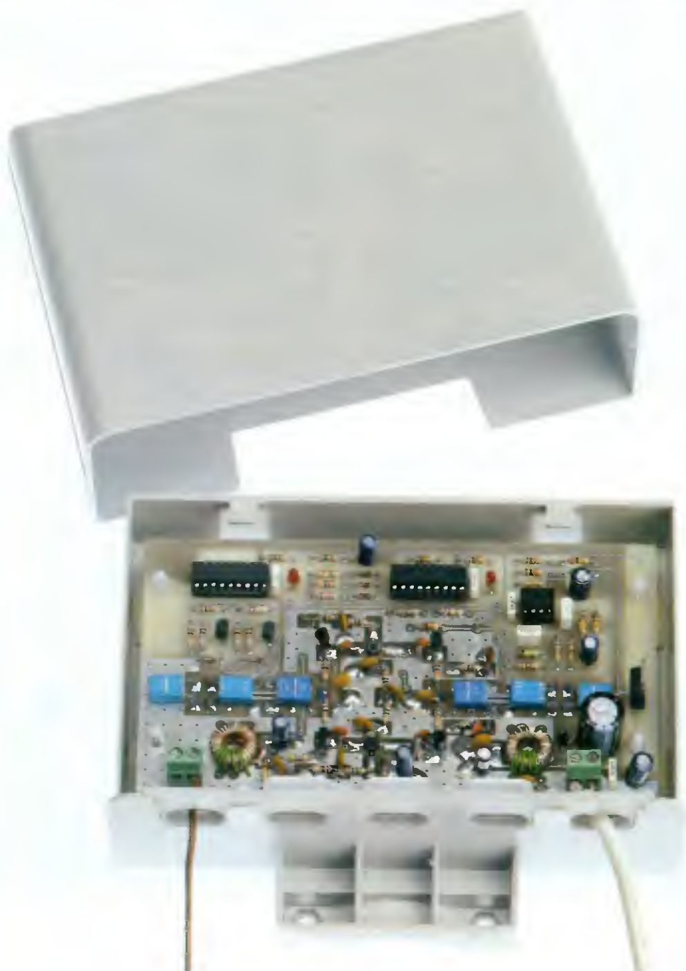
Fig.11 Il Preamplificatore d'antenna LX.1656 andrà inserito nel mobile plastico siglato MTK13.04 provvisto di un coperchio plastico ad incasso, per evitare che la pioggia o la neve possano penetrare al suo interno. Questo mobile è completo di una zanca di fissaggio metallica per poterlo fissare su qualsiasi palo, anche quello di un'antenna TV (vedi fig.18). Nei fori presenti sul lato inferiore del mobile inserirete il filo dell'Antenna e quello del cavo coassiale.
