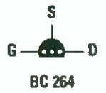
Fig.2 Connessioni dei transistor BC.547-BC.557 e del fet BC.264 viste da sotto. Le connessioni dei mosfet finali IRF.520 e IRF.9530 sono viste di fronte, mentre quelle dei mosfet di media potenza IRFD.110 e IRFD.9110 sono viste da sopra.
