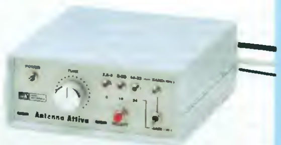
Fig.16 Foto della Centralina di comando siglata LX.1657 già fissata all'interno del mobile plastico. Il trimmer R3 posto in serie al potenziometro R1 (vedi fig.2) serve per variare il valore di tensione sui diodi Varicap, quindi a correggere la frequenza di sintonia.
