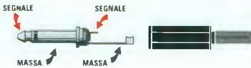
Fig.4 Negli spinotti jack Mono il segnale BF fa capo alla testa dello spinotto e la massa al cilindro metallico esterno.
