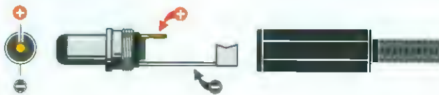
Fig.1 Negli spinotti per l'alimentazione, il foro "centrale" è collegato al Positivo ed il cilindro esterno al Negativo.
