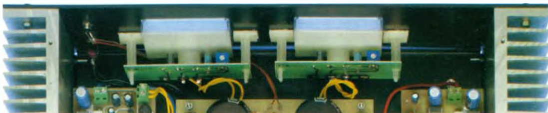
Fig.19 Particolare del montaggio dei due strumentini Vu-Meter siglati LX.1115 (uno per ogni canale) fissati al pannello frontale del mobile con i distanziatori autoadesivi.
