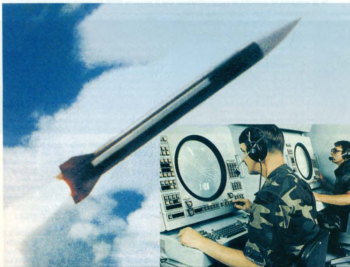
Fig.17 Nelle ogive di tutti i missili aria-aria o terra-aria risultano installati dei sensibili sensori a raggi infrarossi in grado di pilotare i missili verso il calore generato dai reattori di un velivolo nemico. Per poterli evitare, furono studiate delle efficaci contromisure, come ad esempio le "palle di fuoco" chiamate anche "infrared flares".
