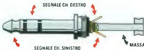
Fig.7 Negli spinotti Jack Stereo da 6,3 mm vi sono tre terminali. In quello più lungo viene collegata la calza di Schermo e nei più corti i fili dei segnali Destro e Sinistro.
