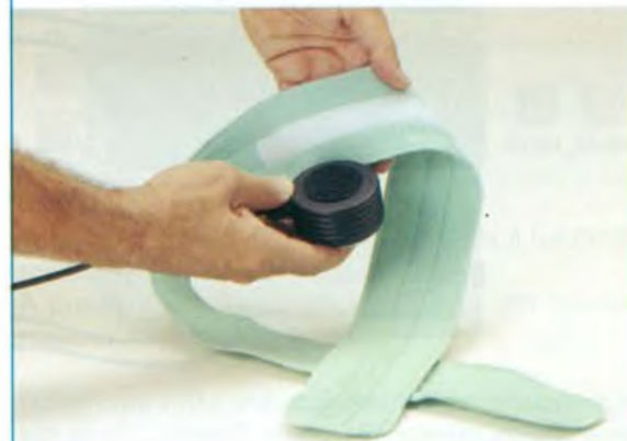
Fig.28 Prima di posizionare il trasduttore sulla parte prescelta applicate sul suo corpo il ritaglio di velcro adesivo per effettuare il fissaggio alla fascia applicativa.
