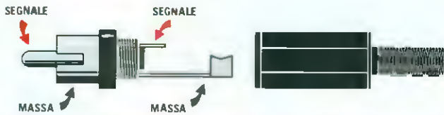
Fig.3 Negli spinotti di BF il perno centrale è quello del segnale BF, mentre la Massa è collegata al cilindro esterno.
