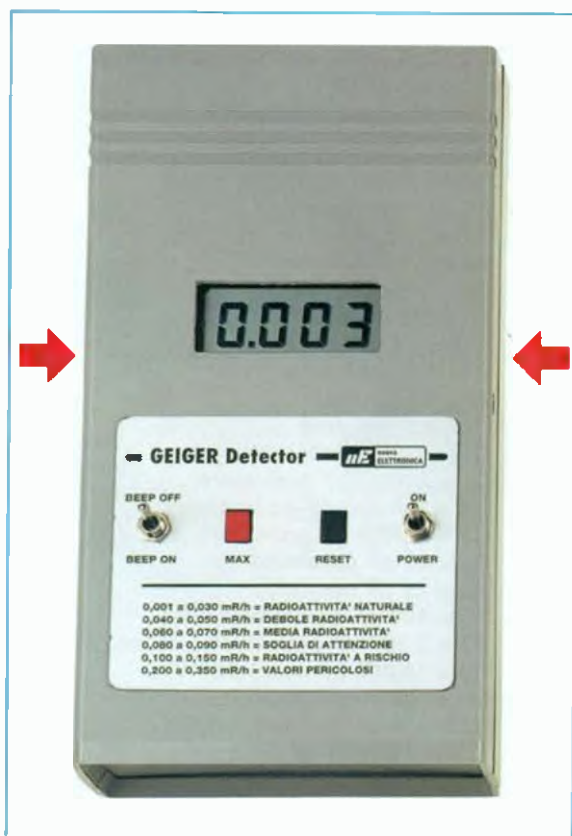
Fig.2 Ecco come si presenta il contatore Geiger una volta racchiuso all'interno del suo mobile. Le frecce disegnate ai lati di quest'ultimo indicano le due asole nelle quali occorre inserire la lama di un cacciavite per poterlo aprire (vedi fig.11).
