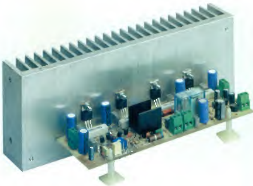
Fig.8 Foto del canale sinistro dell'amplificatore LX.1650 montato sulla sua aletta. La ripresa fotografica vi consente di vedere chiaramente anche il piccolo dissipatore che va appoggiato sui quattro mosfet di media potenza e poi bloccato al circuito con un bullone.
