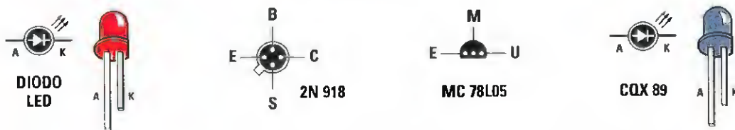
Fig.11 In figura sono rappresentate le connessioni del diodo led DL1 e del diodo ad infrarossi CQX89 nelle quali l'anodo corrisponde al terminale più lungo. Le connessioni del transistor 2N918 e del regolatore di tensione MC78L05 sono invece viste dal basso.
