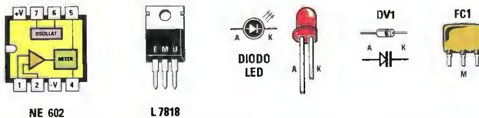
Fig.5 Connessioni dell'NE.602 e dell'L.7818 visti da sopra. Per il diodo Led il terminale K è quello più corto mentre per il diodo Varicap è quello posto dal lato della fascia di riferimento. Per il Filtro FC1 il terminale Massa è quello centrale.
