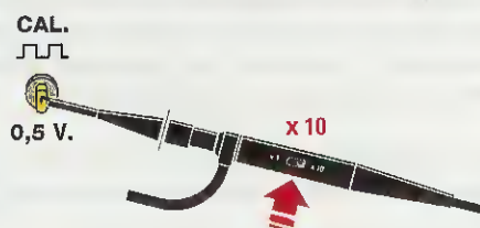
Fig.13 Se il deviatore presente nel puntale risulta posto su x10 e volete vedere nuovamente un segnale con la medesima ampiezza di quello di fig.12, dovete spostare il selettore CH1 dalla portata "0,1 volt x divisione" (vedi fig.12) alla portata "10 millivolt x divisione" in modo da aumentare la sensibilità.
