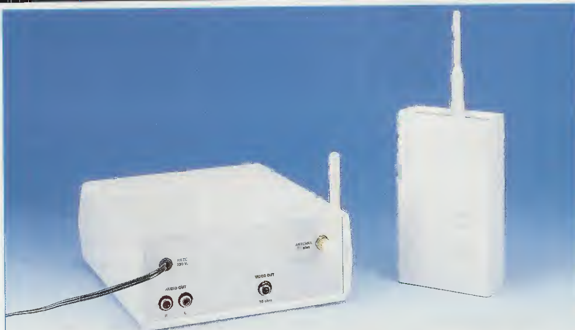
Fig.1 Nella foto in alto a sinistra, potete vedere il frontale del Ricevitore, mentre nella foto qui sopra la parte posteriore dove si può notare che lo Stilo ricevente, anziché risultare a "I" come quello utilizzato nello stadio Trasmettente, risulta ripiegato a "L" per irradiare il segnale SHF con una polarizzazione verticale.
