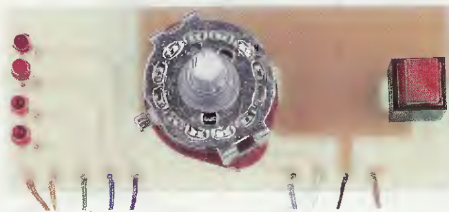
Fig.9 Dopo aver montato la scheda base LX.1558 la dovrete fissare nel mobile plastico che vi forniamo assieme al kit. Di lato la scheda del cambio gamma da fissare sul pannello frontale.
