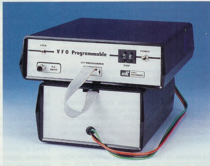
Fig.6 Sul pannello frontale del VFO programmabile è presente un connettore a vaschetta che va collegato al programmatore LX.1546 e all'alimentatore siglato LX.1203 (vedi foto in fig.4) tramite una piattina cablata (PT 10.30) che vi verrà fornita quando ordinerete il kit LX.1565.
