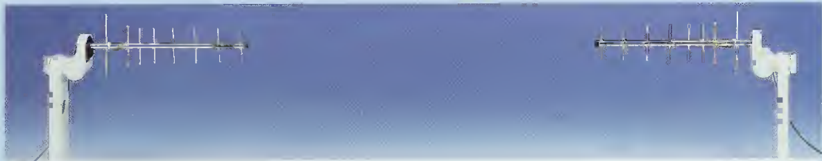
Fig.14 Potrete collocare gli elementi delle due antenne Yagi in senso Verticale e come visibile nella Tabella sottostante, otterrete sempre un segnale che riesce a raggiungere un valore di 2,4 volt. Nel supporto plastico di queste Yagi sono presenti due viti a galletti per poter muovere l'antenna in ogni posizione.
