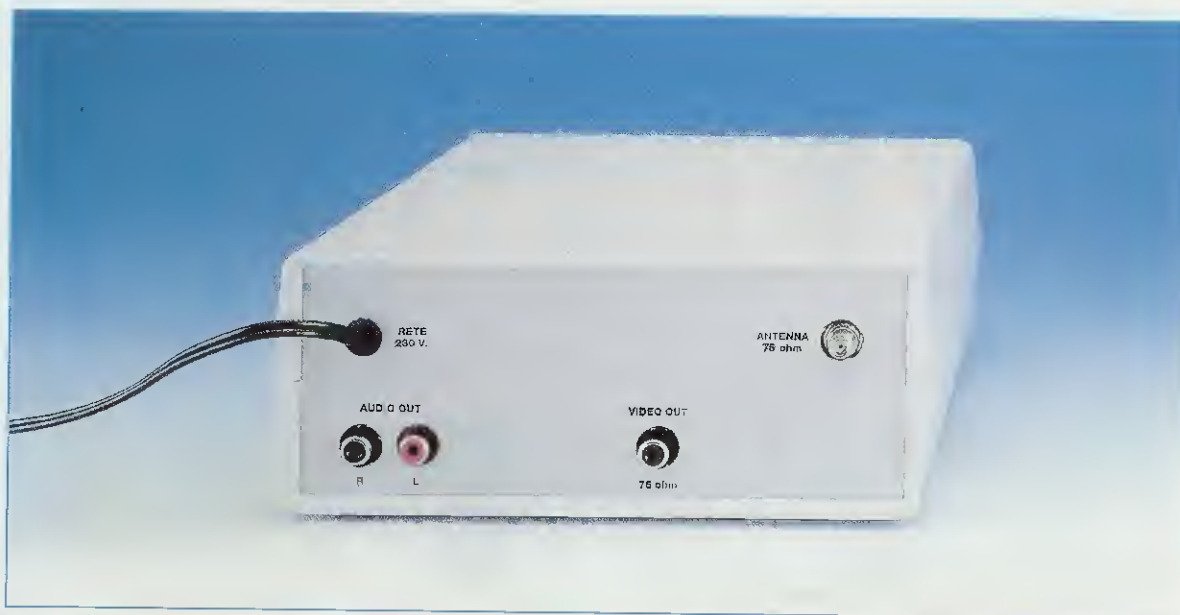
Fig.4 Sul pannello posteriore del mobile è presente, a destra, il connettore per l'antenna ricevente, che può essere una Stilo a "L" come visibile in fig.1 oppure l'antenna Yagi a 8 elementi visibile in fig.18, che permette di aumentare il guadagno di circa 13 dB.
