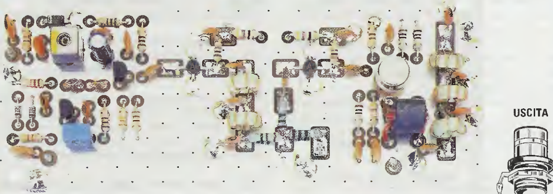
Fig.14 La foto dello stadio VCO realizzato su un circuito stampato a doppia faccia a montaggio ultimato. I circuiti che vi forniamo sono completi di disegno serigrafico e tutte le piste in rame sono protette da una vernice antiossidante cotta in un forno a microonde.
