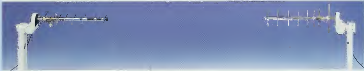
Fig.15 Se nel trasmettitore collocherete gli elementi in posizione Orizzontale e nel Ricevitore li collocherete in senso Verticale, il segnale si attenuerà notevolmente e, come potete vedere nella Tabella sottostante, otterrete un segnale di soli 1,8 volt, cioè identico a quello che si ottiene utilizzando due comuni antenne a Stilo.
