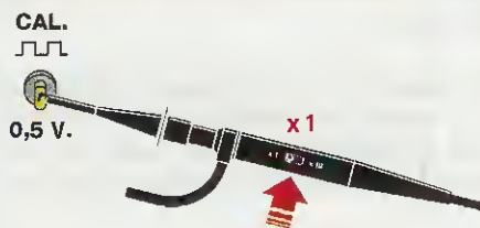
Fig.12 Ruotando la manopola Time/div. sulla posizione "0,2 millisecondi" e la manopola del Volts/div. sulla portata "0,1 volt x divisione", sullo schermo appariranno 2 onde quadre con un'ampiezza di 5 quadretti solo se dal terminale CAL esce un segnale di 0,5 volt e il deviatore del puntale risulta posto su x1.
