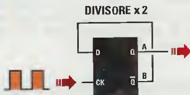
Fig.550 Collegando l'ingresso D di questo flip-flop all'uscita QB, dal piedino d'uscita QA viene prelevata la frequenza applicata sul piedino CK divisa x2. Quindi, applicando una frequenza di 100 KHz sull'ingresso CK dall'uscita QA si preleveranno 50 KHz.
