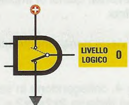
Fig.531 Quando un terminale è a Livello Logico 0 può essere considerato internamente collegato a Massa .
