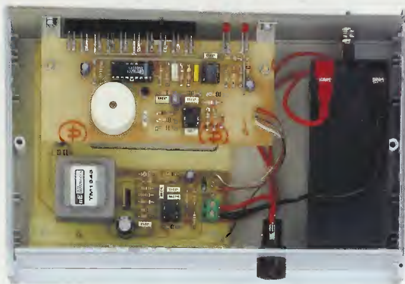
Fig.10 Il circuito stampato siglato LX.1480/B dei diodi led va fissato sul pannello frontale con le due squadrette metalliche riprodotte in fig.12.
