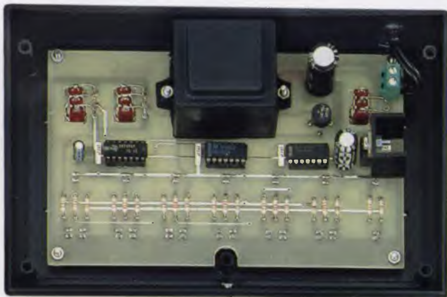
Fig.599 Foto del circuito stampato visto dal lato dei componenti. I diodi led andranno montati sul lato opposto.
