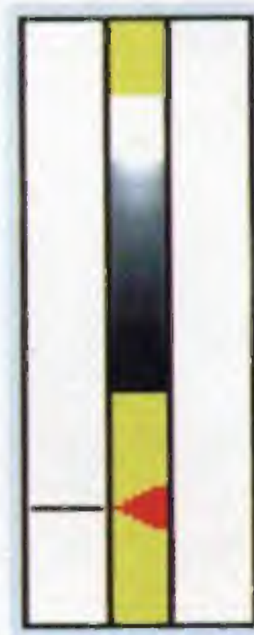
Fig.20 In trasmissione vedrete scorrere verso il basso tre barre a colori. Passando in ricezione dovreste sintonizzare il ricevitore fino a centrare il cuneo sulla riga.
