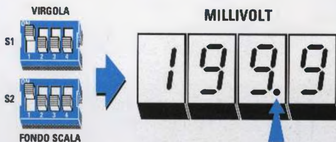
Fig.3 Spostando la prima leva di S1-S2 verso l'alto predisporrete il voltmetro per leggere 199,9 millivolt fondo scala.
