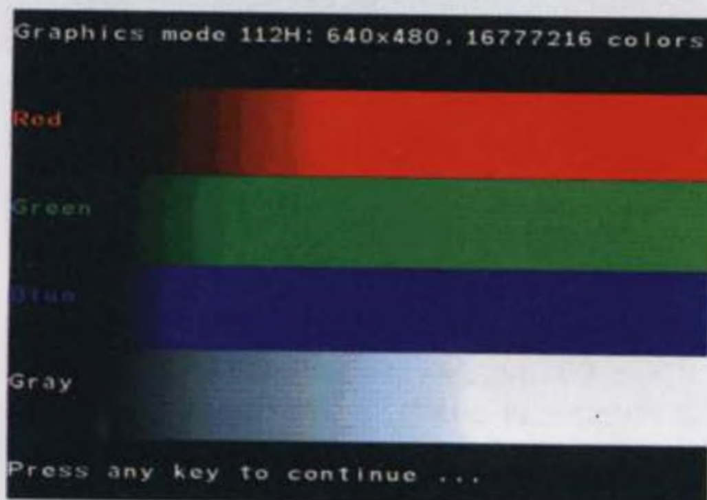
Fig.3 Pigiando un tasto qualsiasi appaiono queste finestre con sopra indicato Mode 12H o 112H ed i relativi livelli di colore.
