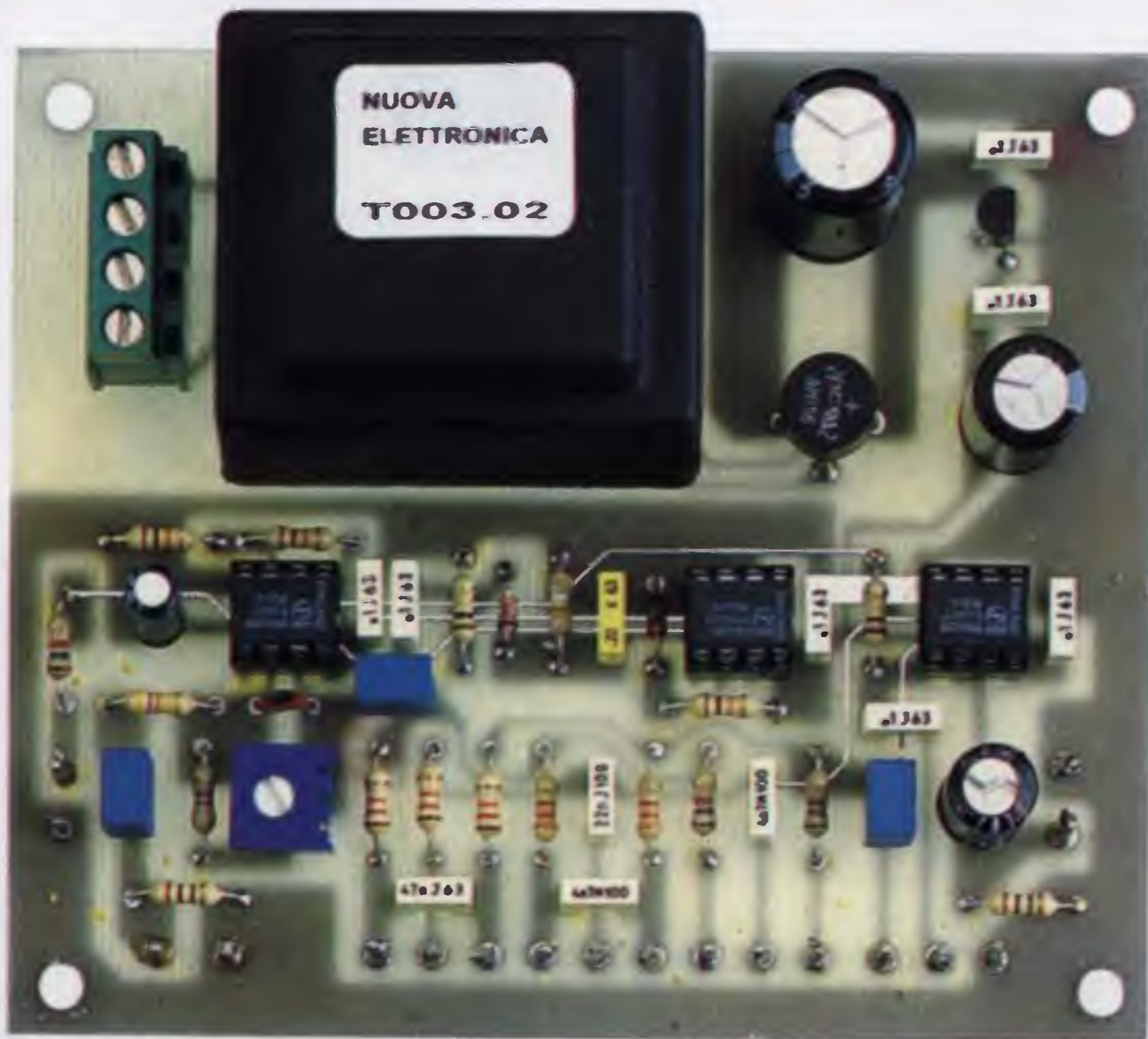
Fig.5 Ecco come si presenta il circuito stampato a montaggio completato. Notate i terminali a spillo per fissare le estremità dei cavetti schermati.
