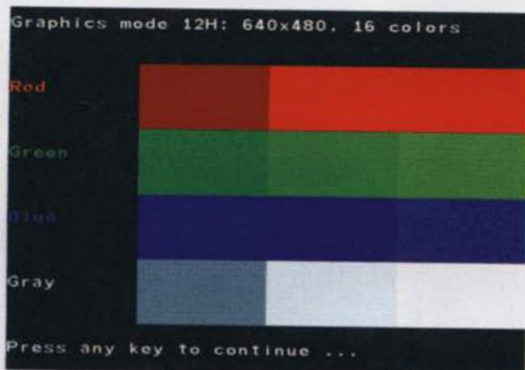
Fig.2 Digitando VGAINFO saprete quanti livelli di colore potete utilizzare con la scheda grafica presente nel computer.
