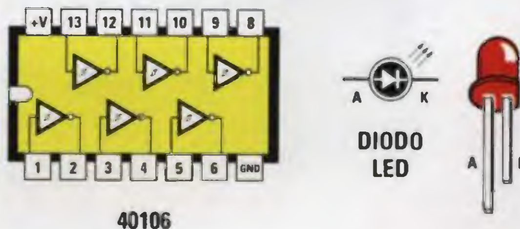
Fig.605 Il corpo dell'integrato 40106 visto da sopra con la numerazione dei piedini. A destra le connessioni A-K del diodo led.
