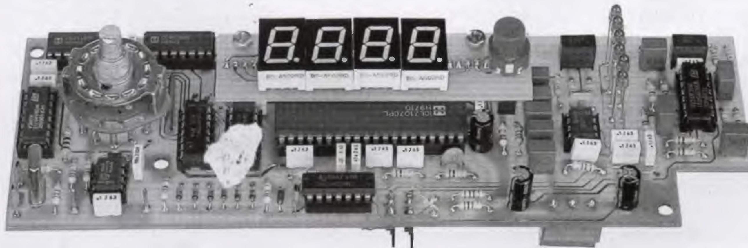
Fig.7 Foto di uno dei nostri primi prototipi. Come potete vedere dallo schema pratico di fig.12, tutti i componenti necessari per realizzare questo capacimetro, escluso il solo stadio di alimentazione LX.1341, risultano montati sul circuito stampato base siglato LX.1340 e sopra il circuito stampato display siglato LX.1340/D. Se effettuerete delle perfette stagnature il capacimetro funzionerà istantaneamente.
