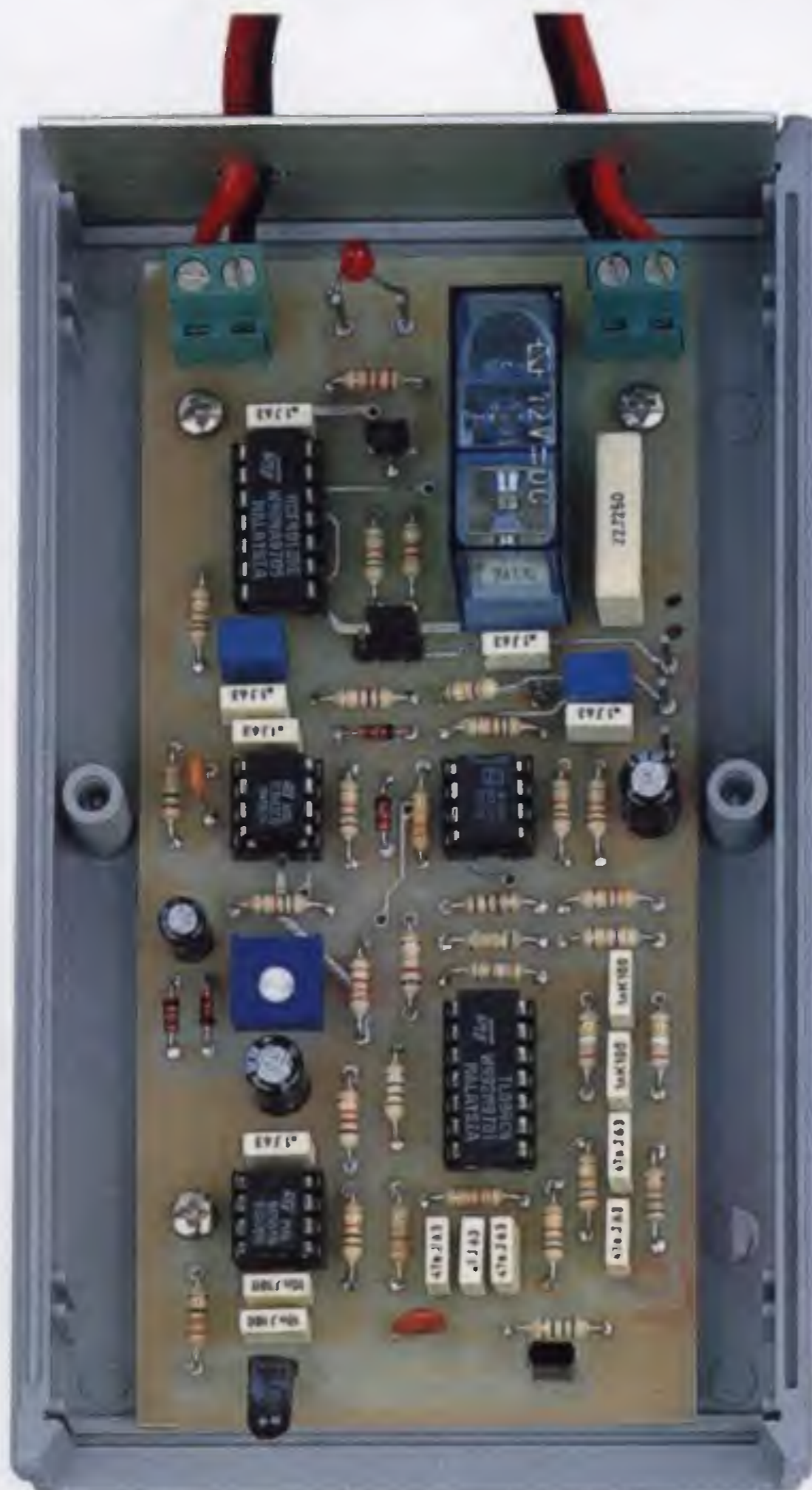
Fig.4 Ecco come si presenta questo microswitch a montaggio ultimato. Le foto che riportiamo sono relative ai 10 primi esemplari realizzati per il collaudo, quindi sul circuito stampato non appare ancora il disegno serigrafico dei componenti e nemmeno la vernice protettiva antiossidante.
