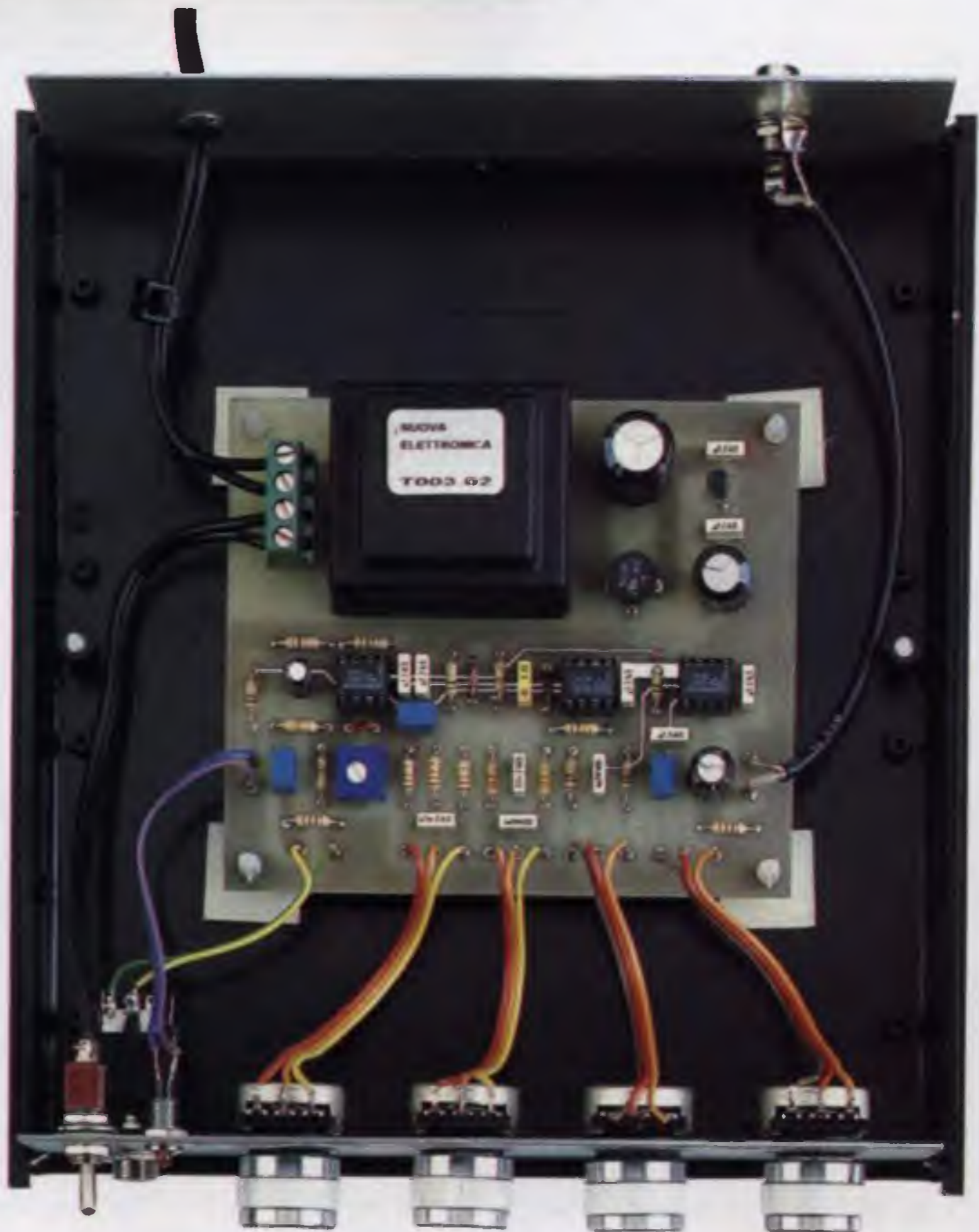
Fig.6 Il circuito stampato andrà fissato all'interno del mobile con i distanziatori plastici, con base autoadesiva, che troverete inclusi nel kit.
