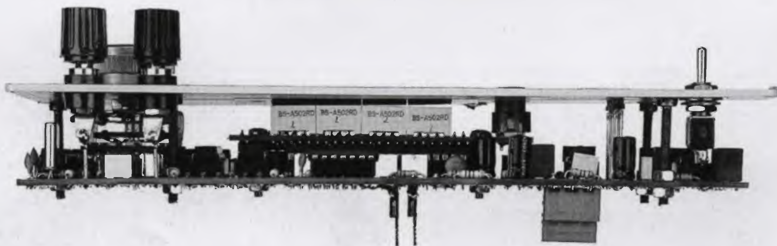
Fig.14 Foto delle due schede LX.1340 - LX.1340/D già fissate sul pannello frontale viste dal lato dei morsetti d'ingresso. Per collegare i terminali dei due morsetti d'ingresso sulle piste del circuito stampato potete utilizzare due corti spezzoni di filo di rame nudo.
