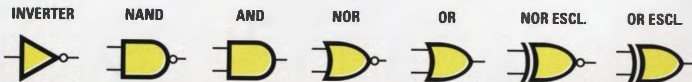
Fig.573 Poiché esistono ben 7 tipi di Porte logiche che commutano le loro Uscite in modo diverso rispetto ai Livelli logici che si applicano sui loro ingressi, per poterle distinguere le une dalle altre vengono disegnate graficamente come visibile in figura.
