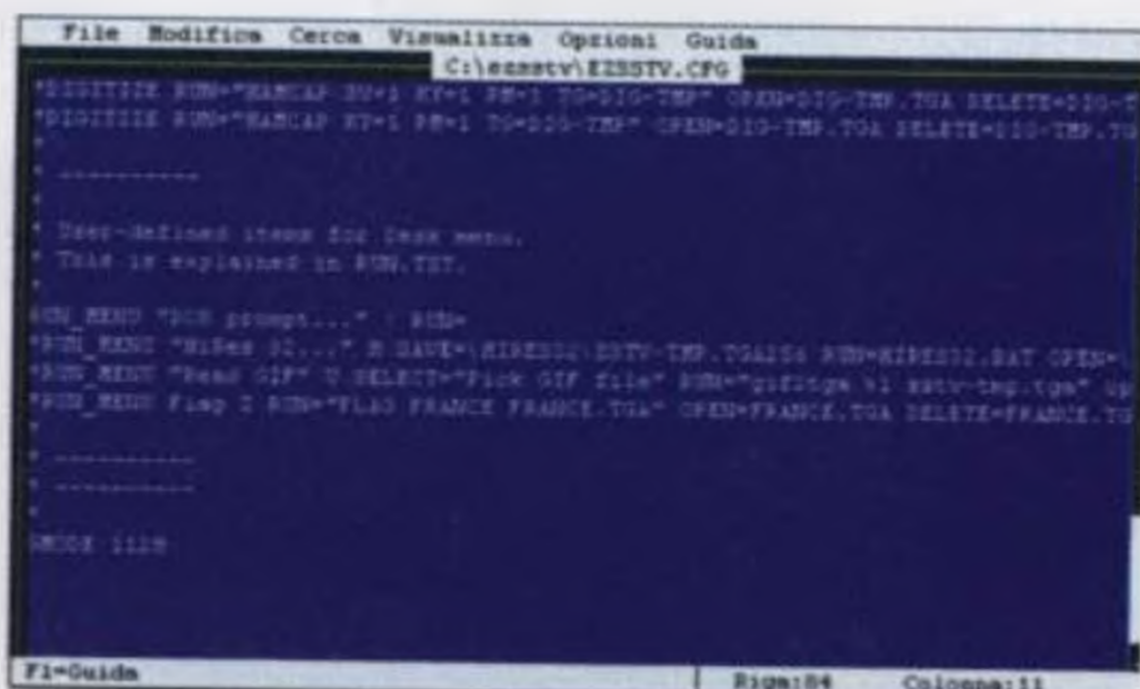
Fig.4 Digitate EDIT EZSSTV.CFG e nella riga in basso scrivete GMODE e il numero scelto, poi digitate Alt+F e S poi Alt+F e X.
