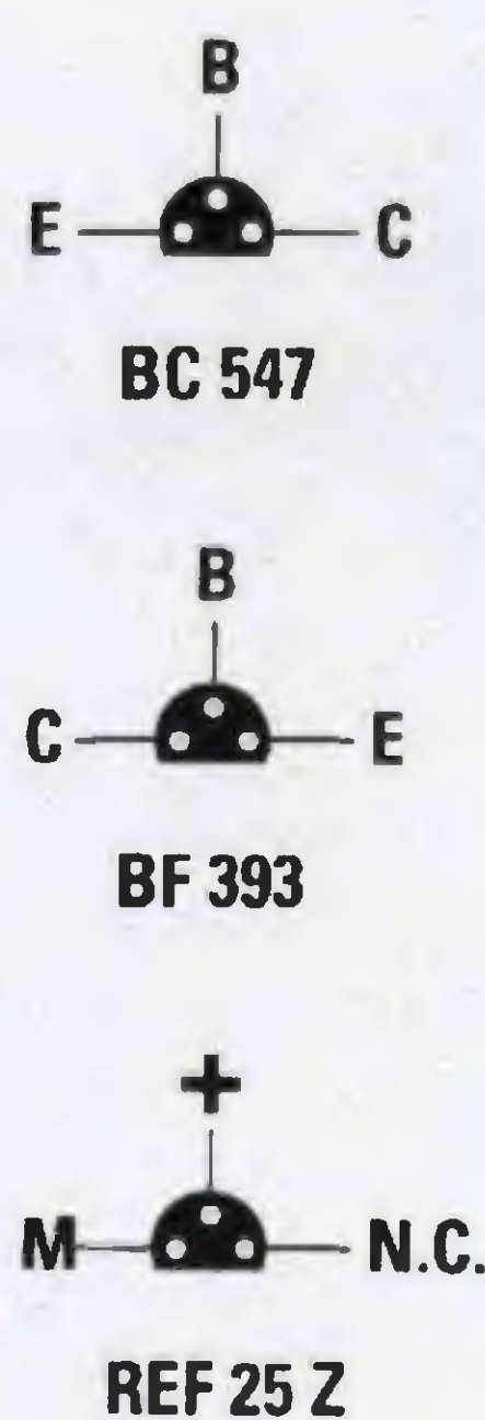
Fig.11 Connessioni viste da "sotto" dei semiconduttori BC.547 - BF.393 - REF.25Z e degli integrati CD.4094 - CD.4093 viste da "sopra" con la tacca ad U a sinistra.
