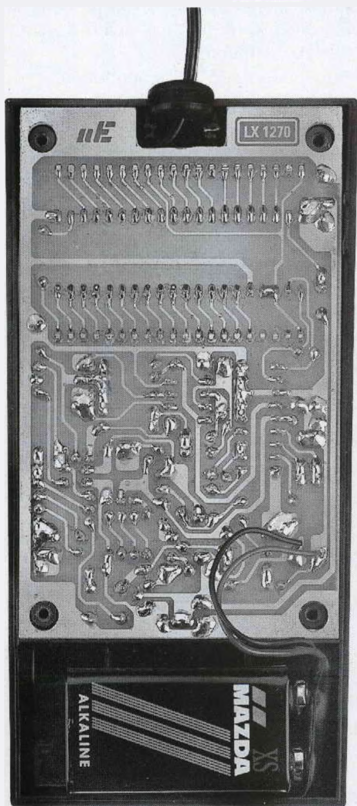
Fig.10 Foto del circuito stampato inserito all'interno del mobile. Quando stagate i due fili del cordone d'uscita cercate di non cortocircuitare le due piste in rame.
