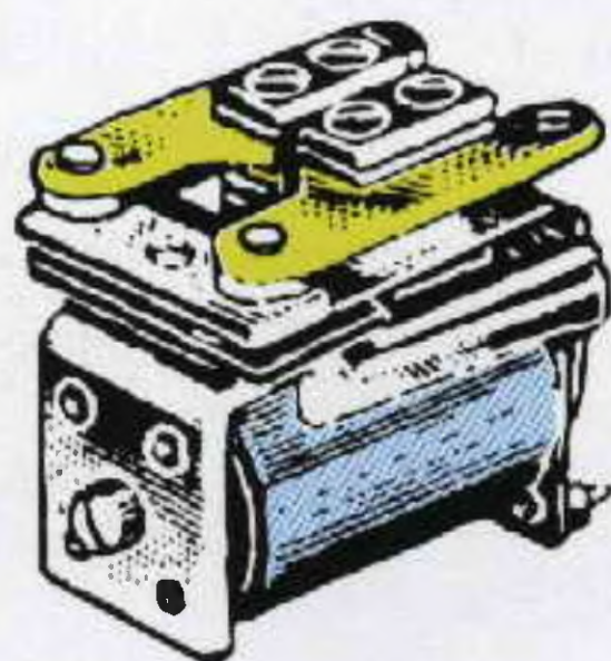
Fig.210 I relè possono assumere forme e dimensioni diverse. Alla bobina di ogni relè dovete applicare la tensione per la quale è stata calcolata, cioè 4 - 6 - 12 - 24 - 48 volt.
