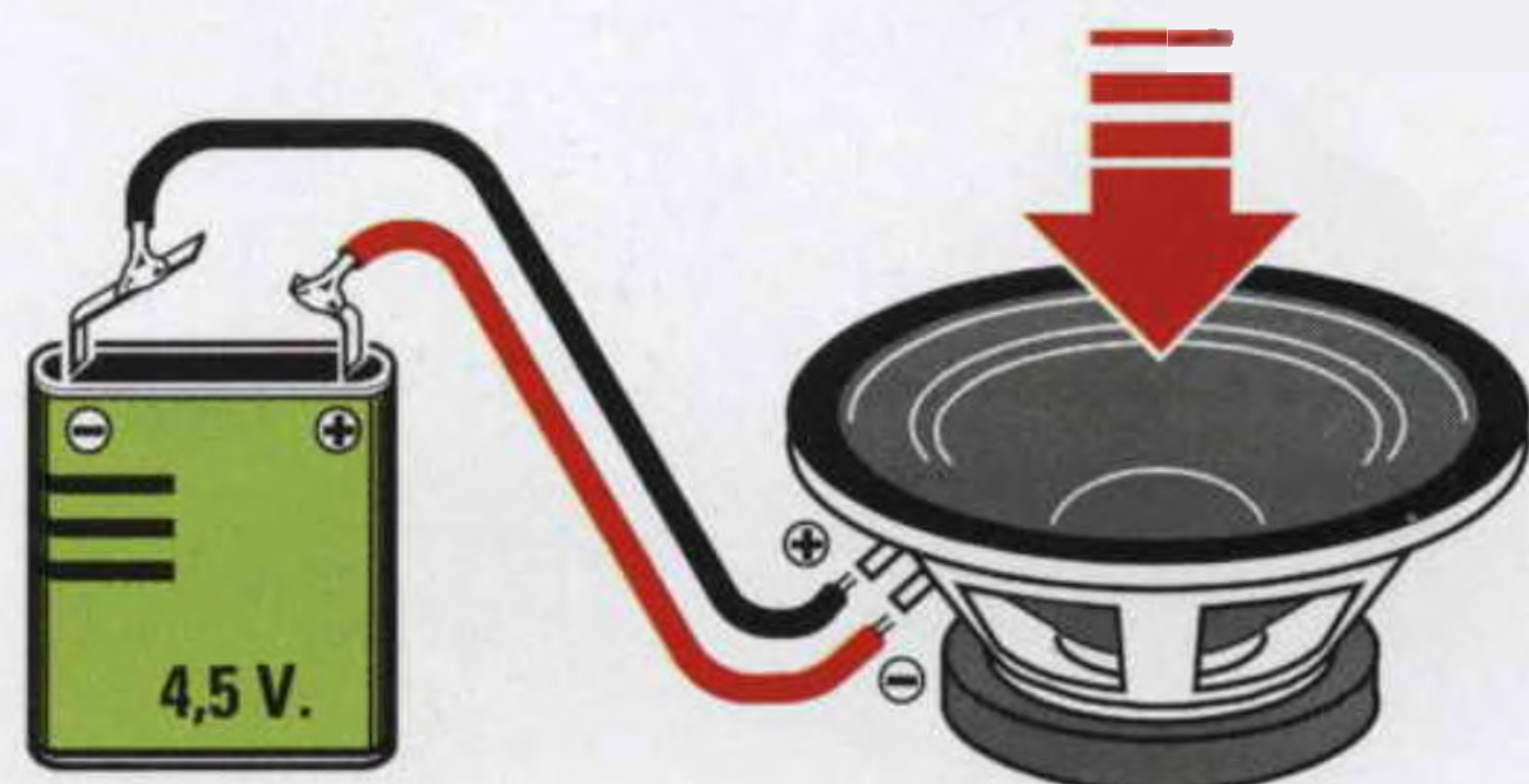
Fig.177 Se invertirete la polarità della pila noterete la membrana spostarsi verso l'interno. Se sulla bobina applichiamo un segnale di BF il cono inizierà a vibrare creando delle onde sonore.
