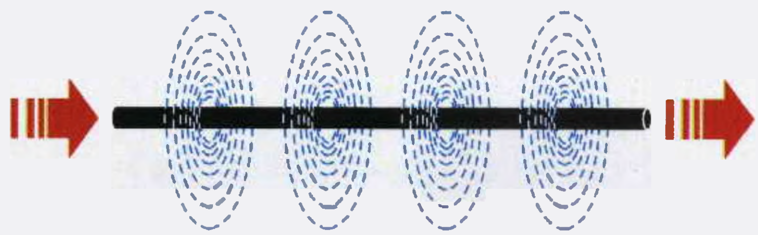
Fig.212 Facendo scorrere una tensione in un filo di rame attorno a questo si creano dei deboli flussi magnetici.
