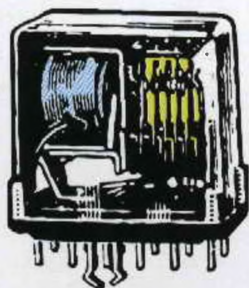
Fig.210 I relè possono assumere forme e dimensioni diverse. Alla bobina di ogni relè dovete applicare la tensione per la quale è stata calcolata, cioè 4 - 6 - 12 - 24 - 48 volt.
