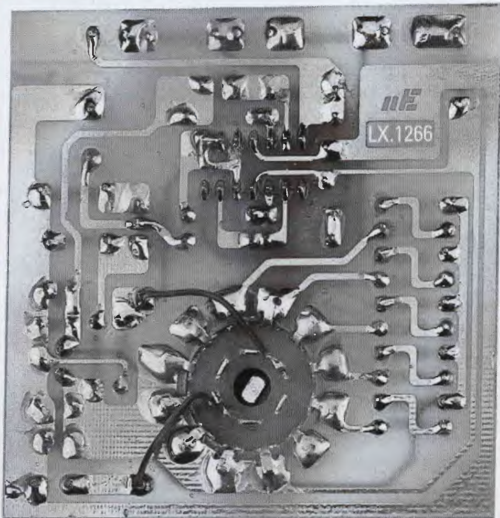
Fig.9 In questa foto vi facciamo vedere come vengono stagnati i terminali del commutatore S1 sulle piste del circuito stampato. Le piste del circuito stampato che vi forniremo sono protette da una vernice isolante.
