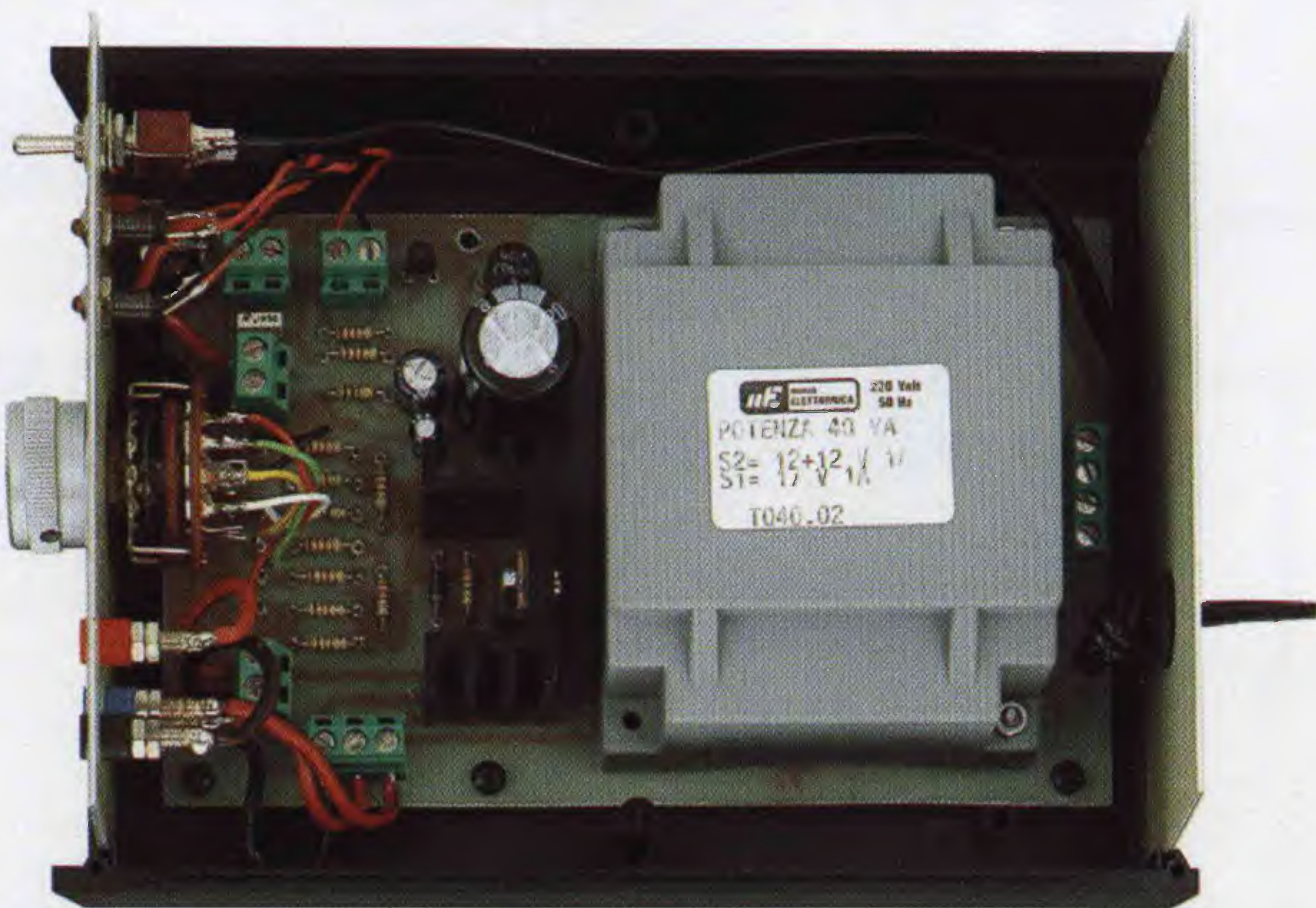
Fig.200 La scheda montata andrà poi fissata all'interno del suo mobile plastico. Sul pannello frontale fisserete il commutatore S2, le boccole d'uscita e le gemme cromate contenenti i diodi led. Per le connessioni al commutatore S2 potrete fare riferimento alla fig.204 e per fissare le boccole d'uscita sul pannello al disegno riportato in fig.206.
