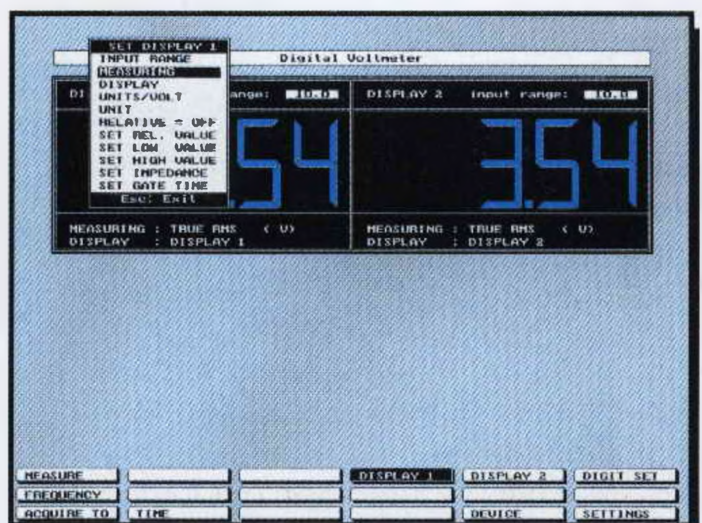
Fig.13 Se volete che uno dei due display vi indichi i volt p/p oppure i dBm o i watt dovrete andare su Measuring pigiare Enter e scegliere una di questa misure.
