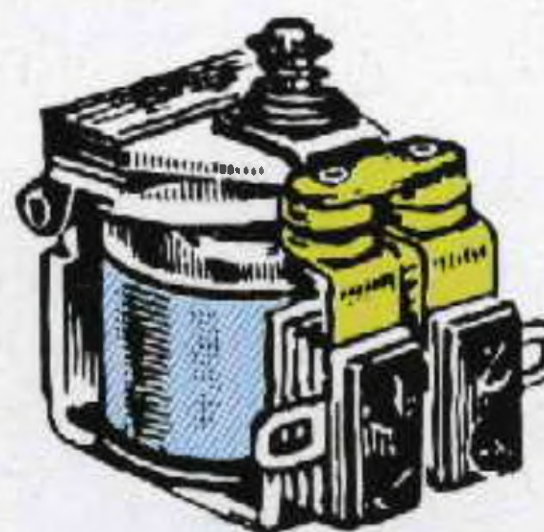
Fig.210 I relè possono assumere forme e dimensioni diverse. Alla bobina di ogni relè dovete applicare la tensione per la quale è stata calcolata, cioè 4 - 6 - 12 - 24 - 48 volt.
