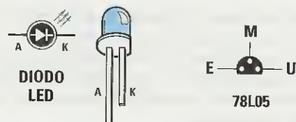
Fig.9 Connessioni dei diodi led e dell'integrato stabilizzatore uA.78L05.
