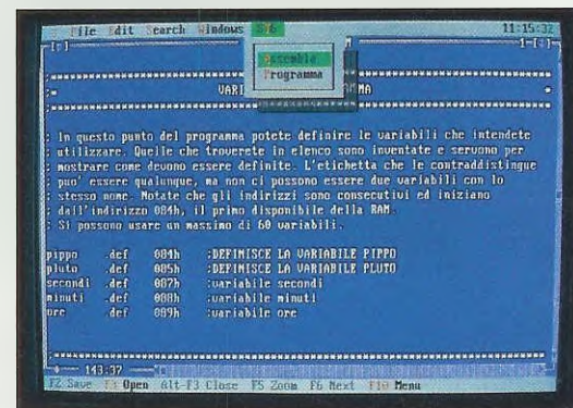
Fig.15 Potrete trasferire il programma scelto nella memoria di un ST6 solo dopo averlo assemblato. Per assemblarlo dovrete premere i tasti ALT+T poi Enter.
