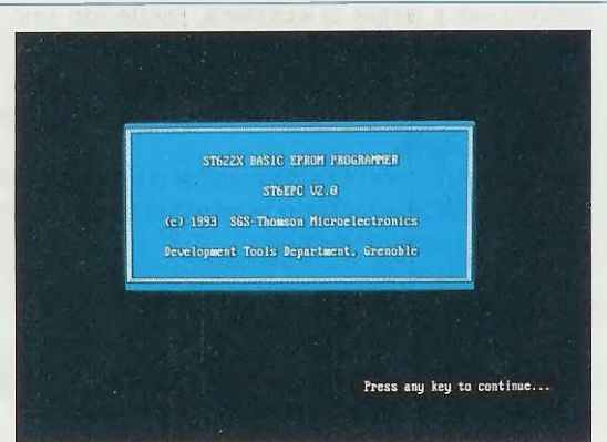
Fig.16 Dopo aver assemblato il programma prescelto (vedi fig.15) pigiate ALT+T poi la lettera P. Quando apparirà questa finestra dovrete premere un tasto qualsiasi.
