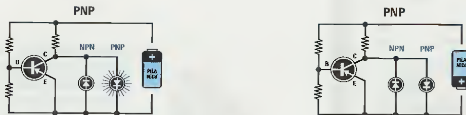
Fig.3 Quando il transistor PNP viene polarizzato con una tensione inversa, cioè con il "positivo" rivolto verso il Collettore, si accenderà il diodo led PNP. Quando viene polarizzato in modo corretto, cioè con il "negativo" rivolto verso il Collettore, i due diodi led rimarranno spenti. Se il transistor è difettoso lampeggeranno entrambi i diodi led.
