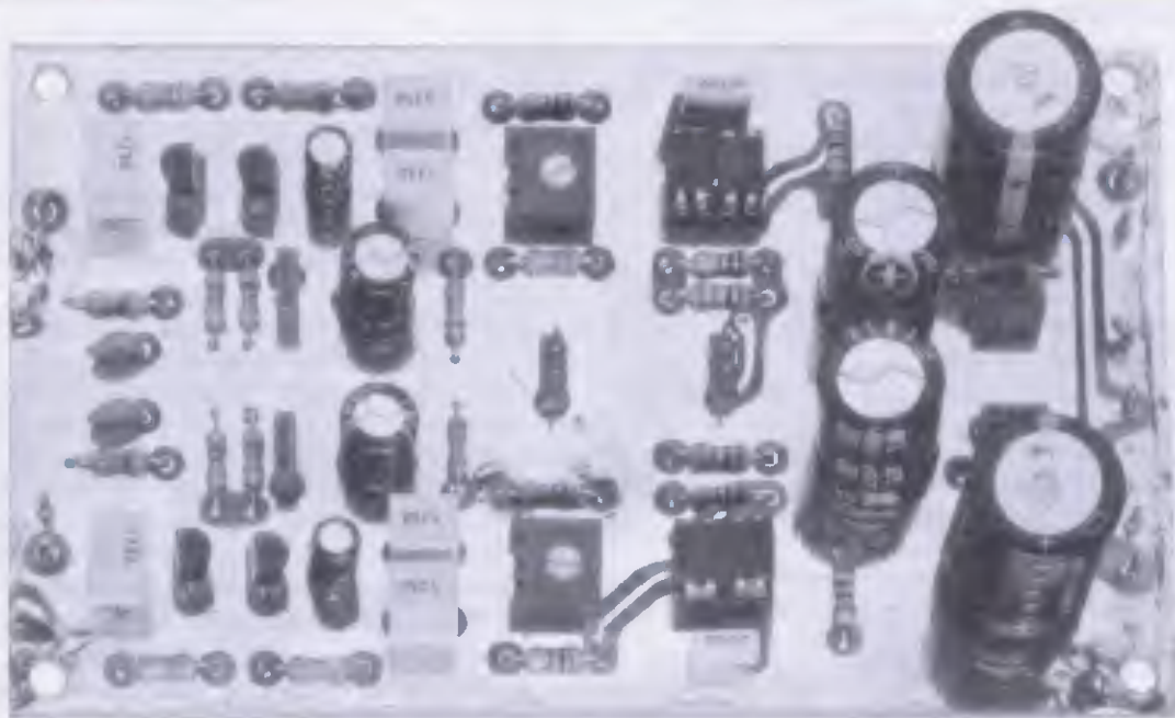
Fig.3 Foto del circuito stampato dell'amplificatore Stereo per cuffia con sopra già montati tutti i componenti. Poiché la foto è leggermente ingrandita, chi volesse conoscere le reali dimensioni del circuito stampato dovrà prendere come riferimento la fig.5.
