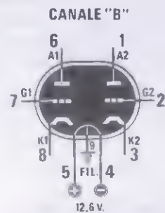
Fig.5 Le connessioni sullo zoccolo dei due doppi triodi sono invertite sul "canale B" rispetto al "canale A" (piedino 2 = G1 per il canale A e piedino 7 = G1 per il canale B) per ottenere un montaggio simmetrico. Per lo stadio di alimentazione andate alla fig.8.
