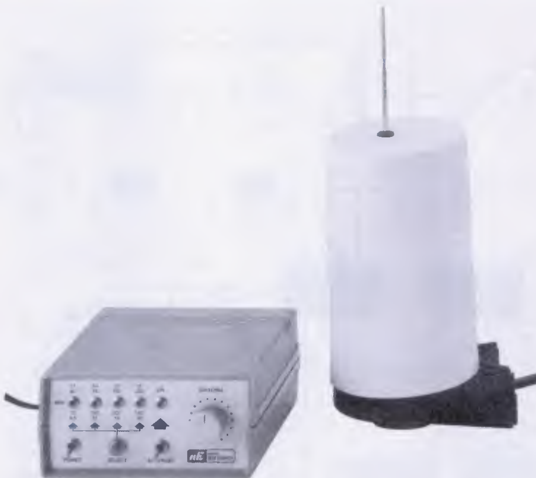
Fig.4 Oltre all'antenna attiva ANT9.30, che vi forniamo già montata e tarata (vedi barilotto bianco posto a destra), dovrete montarvi la centralina LX.1078 (il mobiletto posto sulla sinistra). La centralina vi permetterà di effettuare il cambio gamma, di sintonizzare finemente la sola emittente che vi interessa e di attenuare tutti quei segnali che manderebbero la lancetta dell'S-Meter a fondo scala.
