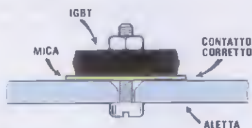
Fig.11 Se il foro dell'aletta presenta tutt'intorno un sottile bordo, che potrebbe tener sollevato l'IGBT (vedi fig.10), bisognerà svasarlo con una punta da trapano da 10-12 mm. Si consiglia di interporre tra il corpo dell'IGBT e la superficie dell'aletta una mica morbida tipo Sil-Pad.
