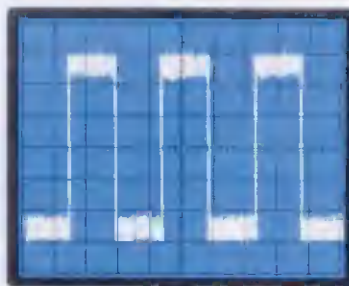
Fig.8 Agendo sul deviatore S3 potrete modulare il segnale RF di questo Generatore di Rumore. Questa funzione risulta molto utile per verificare la risposta del Controllo Automatico di Guadagno di un qualsiasi filtro o modulo di canale.
