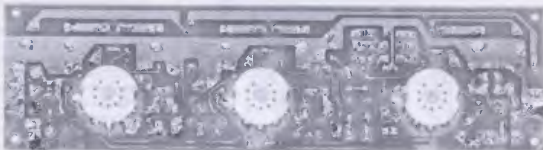
Fig. 16 I tre zoccoli ceramici per le valvole vanno inseriti nel lato dello stampato opposto a quello dei componenti. Saldati i terminali dal lato componenti, controllate che non vi siano dei cortocircuiti.
