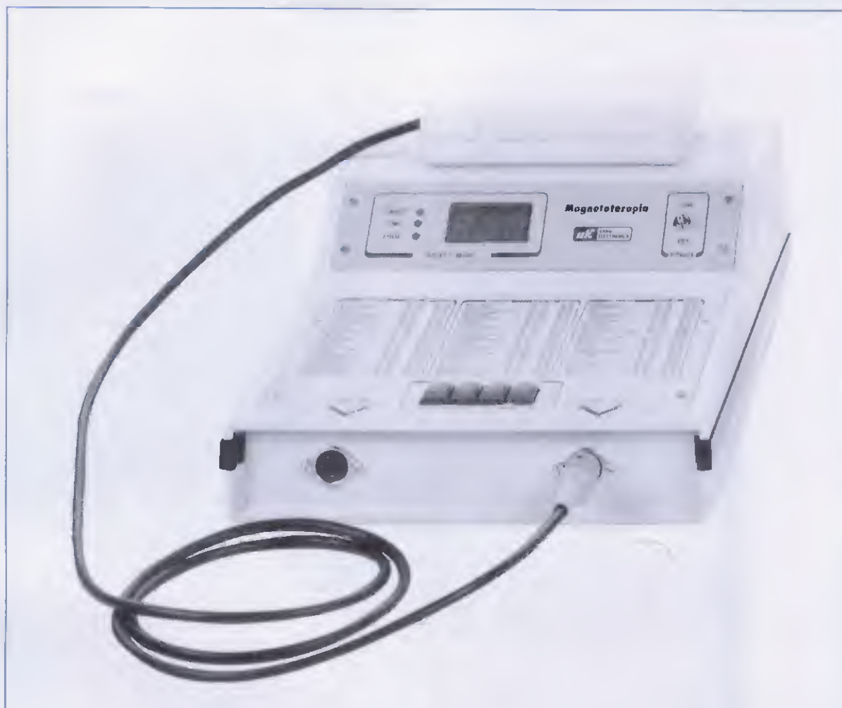
Fig.11 Per individuare la polarità del campo magnetico sarà sufficiente appoggiare il Diffusore Magnetico sul mobile. Se dal lato di contatto esce il flusso "positivo" sul display apparirà il segno +, se capovolgerete il Diffusore, sul display apparirà il segno negativo. Il lato positivo andrà contrassegnato in quanto è quello che dovrete appoggiare sulla parte del corpo per uso terapeutico.
