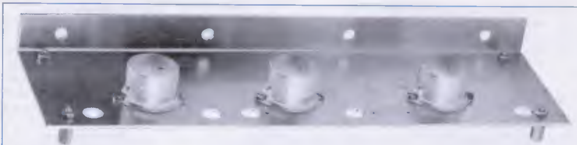
Fig.25 Per tenere distanziato il circuito dalle due squadrette a L, troverete nel kit dei distanziatori in ottone. Questi serviranno anche per collegare a massa i due stampati.
