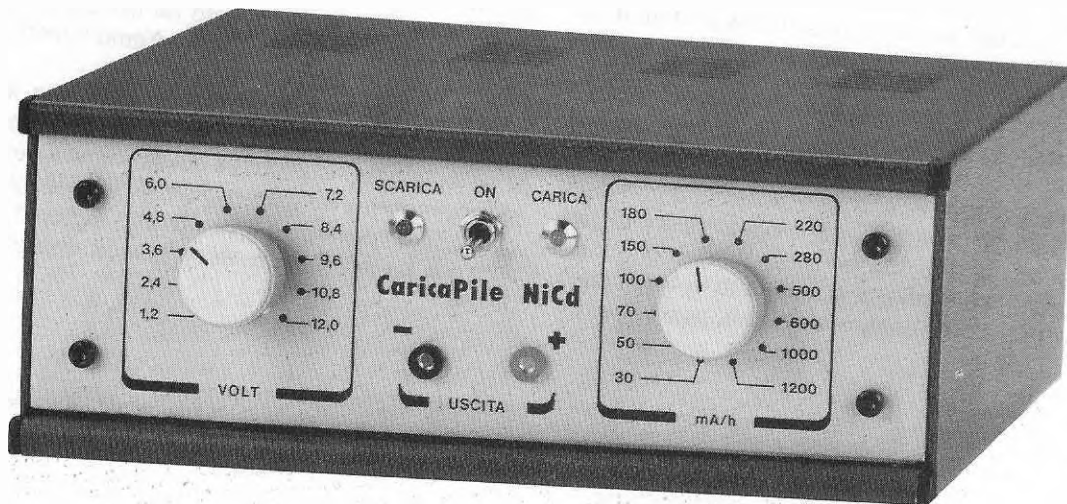
Fig.4 Sul pannello frontale del mobile sono presenti due manopole, quella dei volt e quella dei milliamper/ora, più i due diodi led di controllo. La manopola dei volt andrà ruotata sul valore della tensione della pila, mentre la manopola dei mA/h sulla capacità della pila, quasi sempre indicata sull'involucro. Prima di inserire la pila, dovrete ruotare questi due commutatori sull'esatto valore di tensione e di corrente. Non ruotate mai il commutatore della tensione con la pila inserita.
