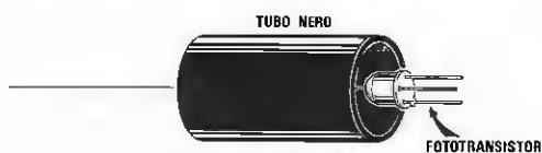
Fig.10 Per evitare che una luce esterna possa saturare il fotodiodo o il fototransistor, vi consigliamo di inserirlo entro un tubo verniciato in nero opaco.
