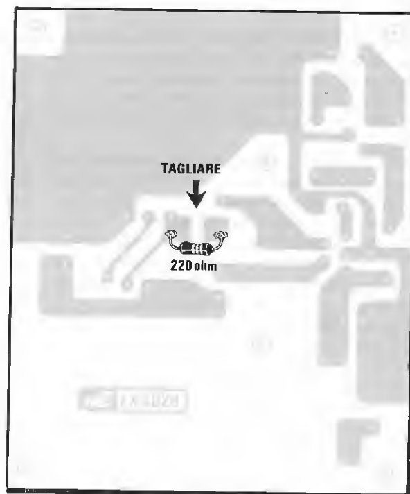
Fig.3 Per la realizzazione pratica vi rimandiamo alla rivista n.145, altrimenti potrete affidarvi al disegno serigrafico visibile sul lato opposto dello stampato. Per inserire la resistenza da 220 ohm in serie al condensatore elettrolitico C6, vi consigliamo di "tranciare" la pista in rame sopra riportata e di saldare i terminali di questa resistenza tra le due piste.
