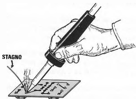
Fig.5 Avvicinate la punta del saldatore ben pulita alla pista dello stampato per riscaldarne la superficie, poi avvicinate a questa il filo di stagno. Quest'ultimo, sciogliendosi, farà fuoriuscire il "disossidante" inserito all'interno della sua anima, che brucerà la pellicola di ossido presente sui terminali e sullo stampato.
