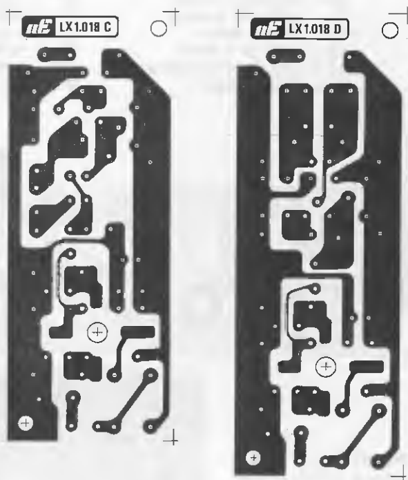
Fig.21 Disegni a grandezza naturale, visti dal lato rame, dei due stampati necessari alla realizzazione degli stadi oscillatori siglati LX.1018/C e LX.1018/D. Gli stampati da noi forniti, sono completi di disegno serigrafico e le piste sono tutte protette con una speciale vernice autoossidante.
