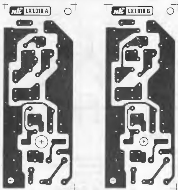
Fig.20 Disegni a grandezza naturale, visti dal lato rame, dei due stampati necessari alla realizzazione degli stadi oscillatori siglati LX.1018/A e LX.1018/B. Si consiglia di utilizzare dei supporti in fibra di vetro per ridurre al minimo le perdite di AF.
