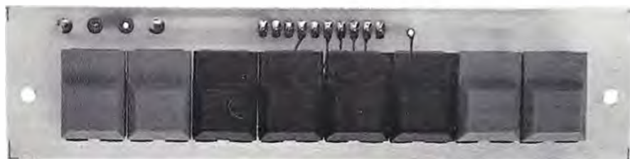
Fig.34 Schema elettrico relativo alla tastiera delle funzioni. I due deviatori Up-Down e Start-Stop come vedesi in fig.1 risultano fissati sul pannello frontale. Qui sotto, la foto della tastiera che, con i suoi otto tasti, vi consentirà di svolgere tutte le funzioni necessarie al funzionamento di questo Video-Converter.
