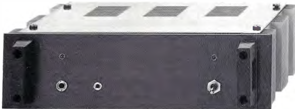
Fig.4 Questa segreteria telefonica potrà essere inserita entro al mobile "nuova serie" MV5.185 che, ovviamente, non presenta il pannello frontale forato. Pertanto, con una punta da trapano, dovrete praticare quei pochi fori richiesti per inserire le due prese femmina jack, l'interruttore di accensione e i due diodi led.
