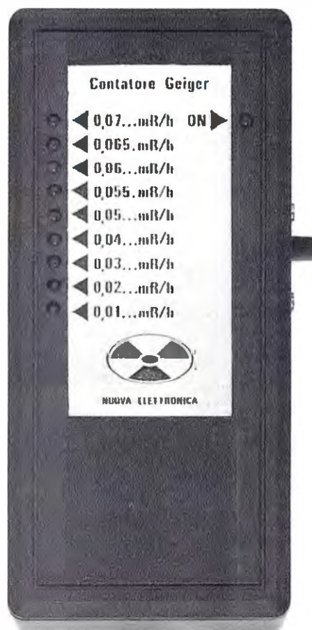
Fig.2 Sul pannello frontale del mobile andrà applicato l'adesivo con riportata la scala in milliRoentgen/ora che troverete nel kit. Tale adesivo non risulterà di colore bianco come riportato nella foto, ma di colore nero.
