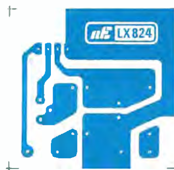
Fig. 12 Disegno a grandezza naturale del circuito stampato LX.824.
