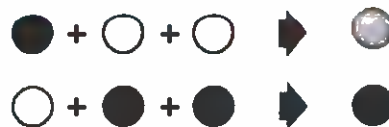
Fig.29 Nel nostro Video-Converter, nei formati condensati tipo 1 e 0, il microprocessore prende questi 3 punti, controlla se i punti Bianchi sono in numero maggiore o minore rispetto quelli Neri, poi "ricrea" un solo punto con un colore proporzionale, cioè grigio chiaro - grigio scuro, ecc.
