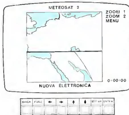
Fig.9 Una volta completata in tale riquadro una immagine totale, se il deviatore Start-Stop si troverà in posizione Start, la successiva immagine cancellerà quella presente per lasciare posto alla successiva. Se vi interesserà tenere una immagine, dovrete spostare il deviatore su Stop.
