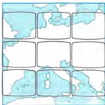
Fig.27 Poichè il satellite trasmette per ogni riga orizzontale 800 punti e in una riga di un normale televisore ve ne stanno solo 256, per visualizzare una immagine completa occorrerebbero ben 9 televisori. Non essendo questa una soluzione attuabile, nel formato Zoom 1 (vedi fig.10 - 12) è possibile prelevare dall'immagine totale quella porzione che può apparire su un solo schermo TV e, così facendo, si ottiene quello che noi chiamiamo ingrandimento.
