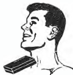
Fig. 14 Per controllare se avete ingerito dei cibi contaminati da iodio radioattivo ^{131} , sarà sufficiente appoggiare il contatore Geiger per qualche minuto sul collo.
