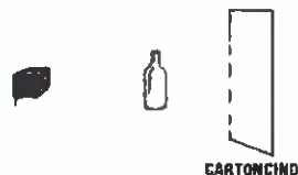
Fig.20 Per constatare se questo sistema risulta valido, fate passare di fronte al sensore una bottiglia piena di acqua calda e vedrete come questa venga subito rivelata.
