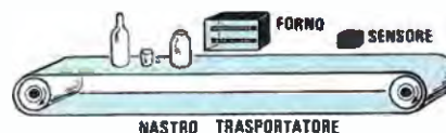
Fig.19 Per contare dei pezzi di vetro trasparente posti su dei nastri trasportatori, potreste surriscaldarli in modo che il sensore capti il "calore" emesso da tali corpi.
