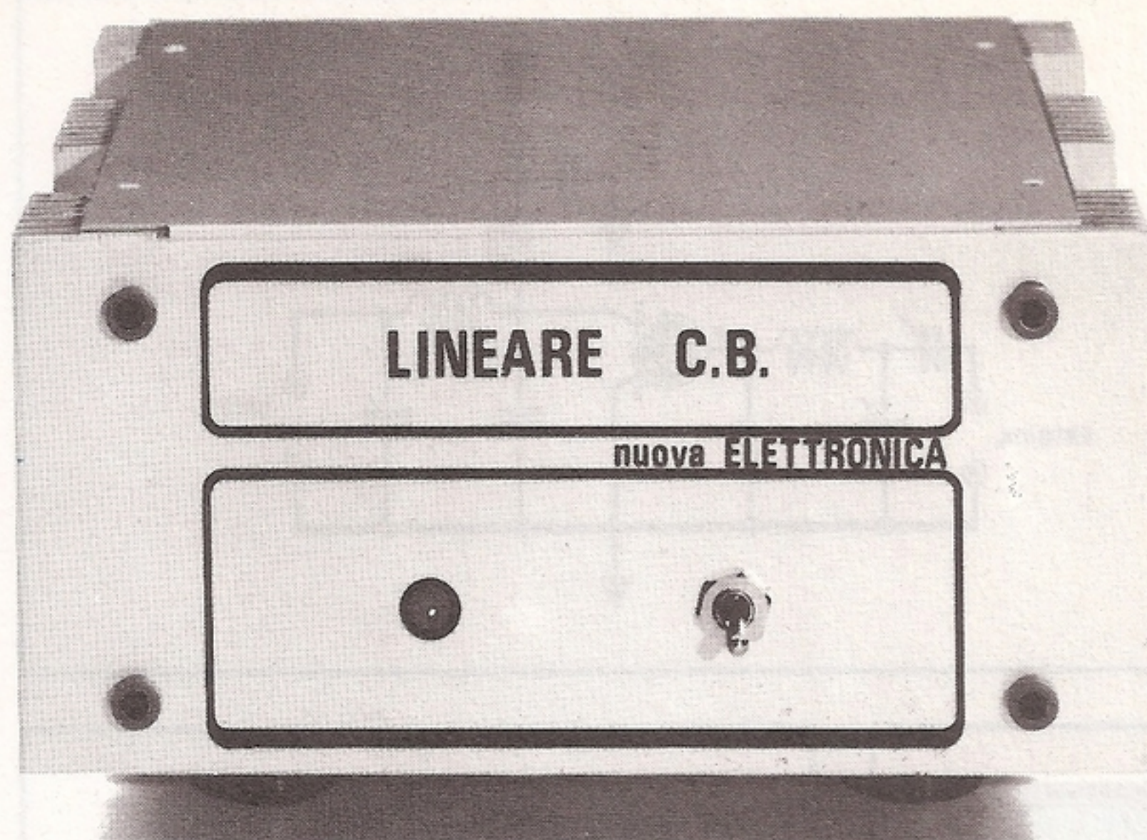
Foto del mobile contenente il Lineare AF e l'amplificatore BF di potenza.
