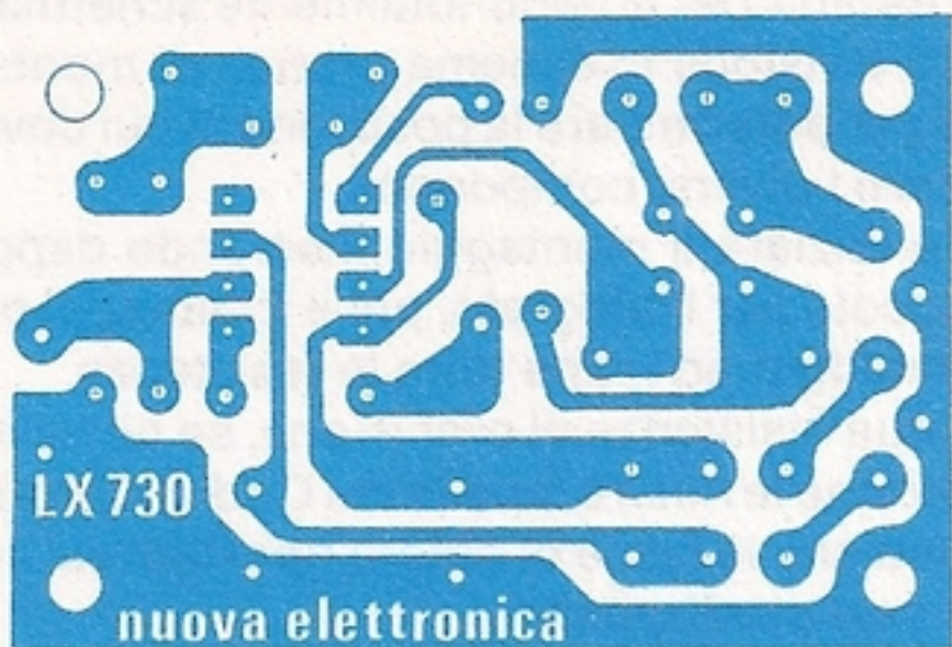
Fig. 2 Disegno a grandezza naturale del circuito stampato.
