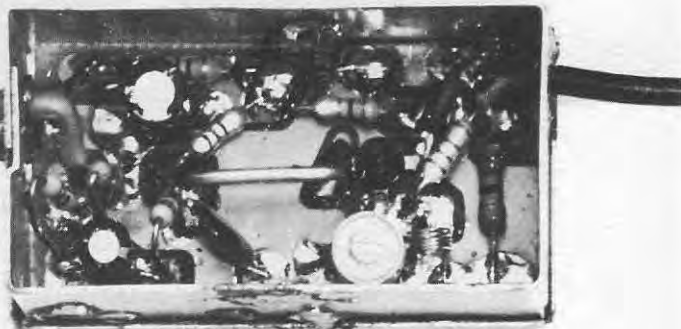
Fig. 6 Foto del modulatore video. Tutti i componenti andranno stagnati direttamente sul lato rame. Si noti la bobina L1 a U vedi fig. 8.
