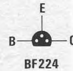
Fig. 10 Connessioni degli integrati, transistor, fet, mosfet e diodi varicap impiegati per la realizzazione del ricevitore per satelliti.
