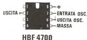
Fig. 2 Connessioni dei terminali dell'integrato HBF.4700 visto da sopra.
