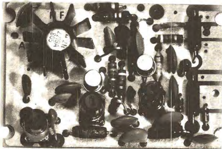
Fig. 8 Foto dello stadio del trasmettitore come si presenta a costruzione ultimata.
