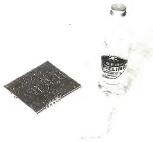
Fig. 2 Se lo stagno utilizzato contiene un disossidante di pessima qualità, prima di alimentare il circuito, pulite tutta la superficie passandovi sopra con un batuffolo di cotone imbevuto di trielina. Qualsiasi altro solvente, alcool, benzina ecc. servirà solo ad imbrattare maggiormente il circuito.
