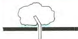
Fig. 18 Se tenete troppo poco il saldatore sul punto da stagnare, lo stagno si attaccherà solo sul terminale, lasciando tra questo ed il circuito stampato uno strato di ossido.
