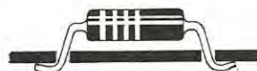
Fig. 14 Non è consigliabile tagliare i terminali prima di stagnarli, né piegarli a pressione sul circuito stampato.
