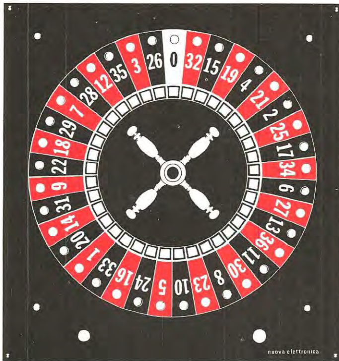
Foto della mascherina in alluminio, già incisa e forata, con la quale potrete completare la roulette digitale presentata in questo articolo.
