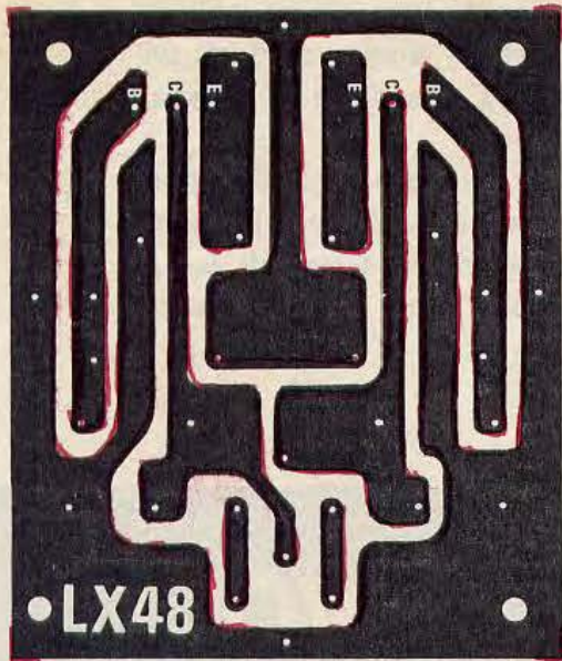
Fig. 2 Circuito stampato a grandezza naturale dell'alimentatore duale.
