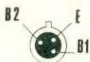
Fig. 3 Connessioni del transistor unigiunzione, viste sempre dal lato che fuoriescono dal corpo, cioè di sotto.
