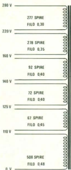
Fig. 11 Se l'avvolgimento primario viene realizzato per diverse tensioni di rete, risulta necessario variare per ogni tensione la sezione del filo, come indichiamo nell'esempio posto qui a sinistra.
