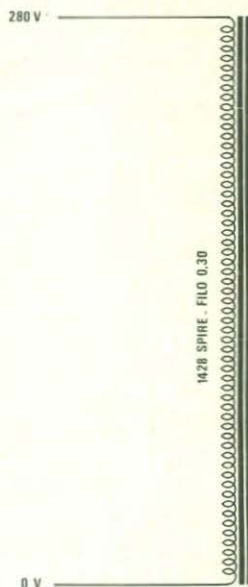
Fig. 11 Se l'avvolgimento primario viene realizzato per diverse tensioni di rete, risulta necessario variare per ogni tensione la sezione del filo, come indichiamo nell'esempio posto qui a sinistra.
