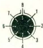
Fig. 11 Connessioni dell'integrato uA.741 visto dal lato dei terminali. Il terminale 8 si trova sempre in corrispondenza della tacca di riferimento.
