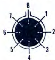
Fig. 5 Connessioni dell'integrato uA.741 visto dal lato dei terminali. Si tenga presente che il terminale in corrispondenza della tacca di riferimento è il piedino 8.
