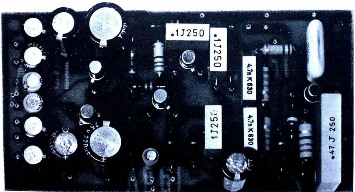
Fig. 7 Sul circuito stampato da noi realizzato troverà posto oltre al circuito di fig. 3 anche quello per l'Ua-Ua di fig. 8 e l'esaltatore di acuti di fig. 9.
