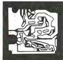
il circuito stampato (positivo) finito e pronto per la foratura in scala 1:1
