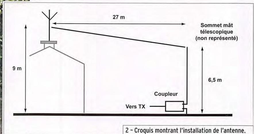
2 - Croquis montrant l'installation de l'antenne.
