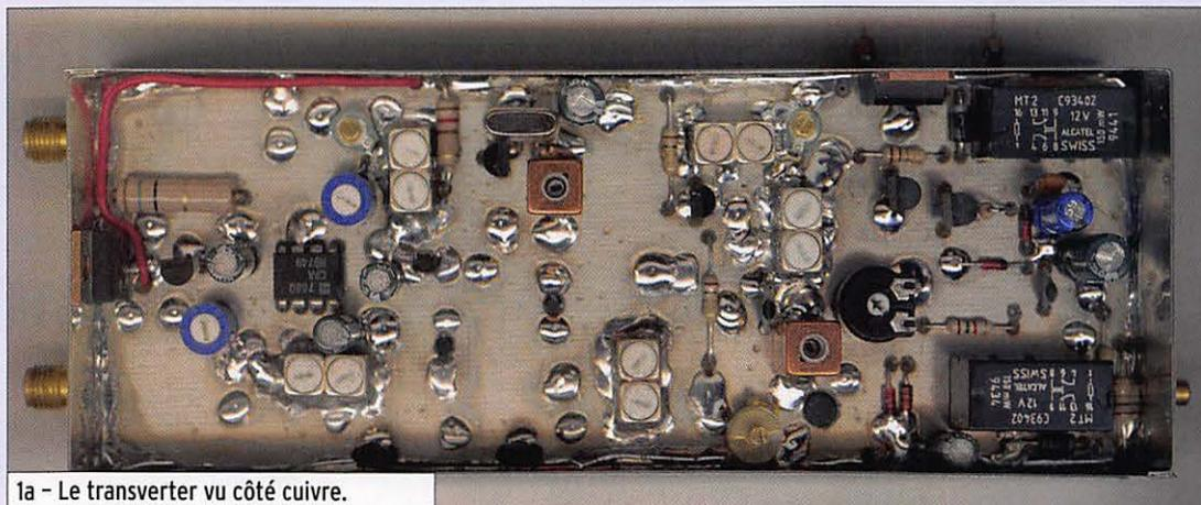
1a - Le transverter vu côté cuivre.
