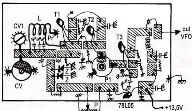
CV1 : Condensateur variable additif type Johanson 10 pf (réglage fin).
