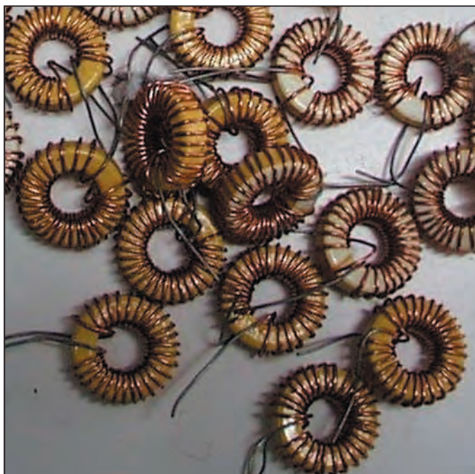
3 - Répartition homogène des spires sur le tore.
