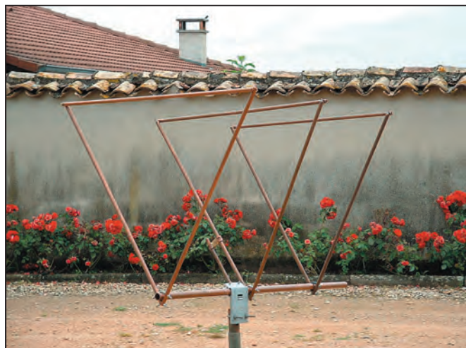
2 - L'antenne 3 éléments, "prototype" en cuivre.
