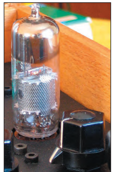
7 - La penthode à pente variable EF85 et le potentiomètre de gain HF.
