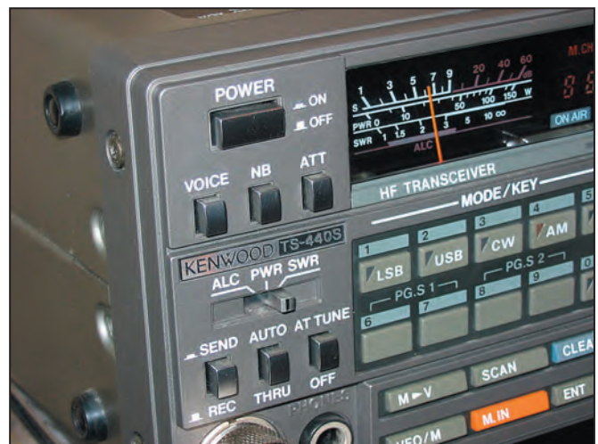
10 - Dans l'angle supérieur gauche de la façade, proche du BP de mise en route, se trouve le BP "Voice". Si l'option VSI (Voice synthesizer) n'est pas montée, ce bouton-poussoir est disponible pour piloter le DSP.
