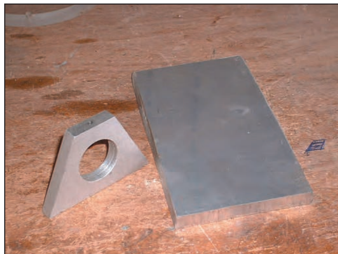
3 - Le support, taillé dans l'aluminium de 10 mm.
