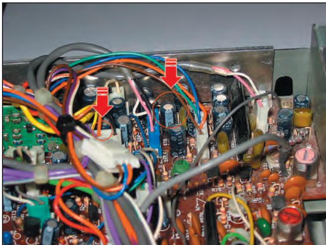
6 - Le coin de la carte "IF Unit", capot supérieur enlevé. On voit le condensateur C69 au fond, derrière C76, entre les 2 connecteurs J2 (bleu) et J6 (blanc), près du bord extérieur de la carte. On devine aussi le connecteur J3 (blanc) de la carte avec son fil orange qui est relié au +8 V.
