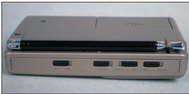
3 - Les commutateurs placés sur la partie supérieure du récepteur.
