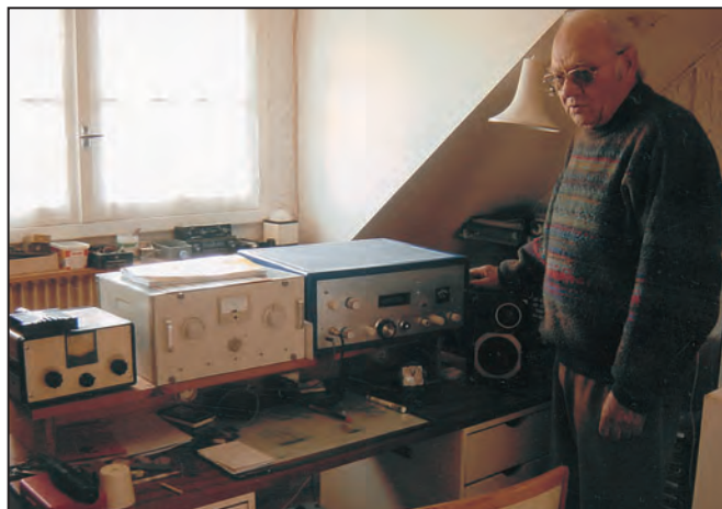
1 - Sur cette table, on ne voit que la station déca : transceiver dont le fréquencemètre est celui de FIBBU, le linéaire (une seule 8122 en service "au petit trot" délivrant 50 à 60 W et la boîte de couplage).
