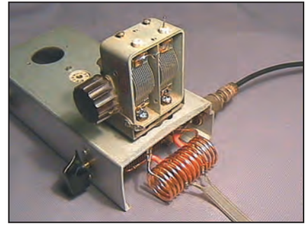
6 - La boîte d'accord, avec CV1.
