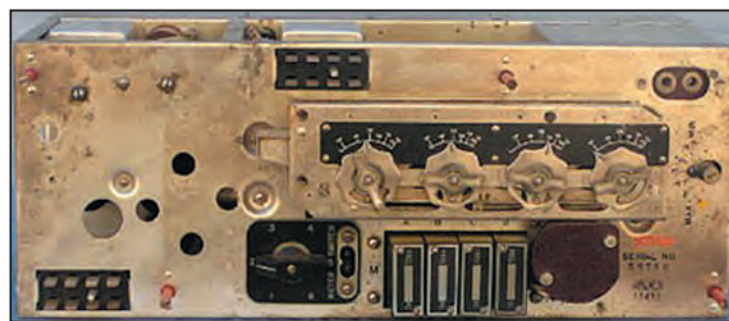
Beaucoup ont débuté en VHF en modifiant du matériel militaire (ici SCR-522 ou BC-625).
