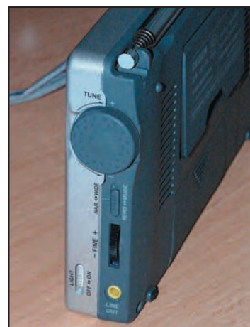
5 - Côté droit : encodeur, sélectivité, BFO, sortie ligne.
