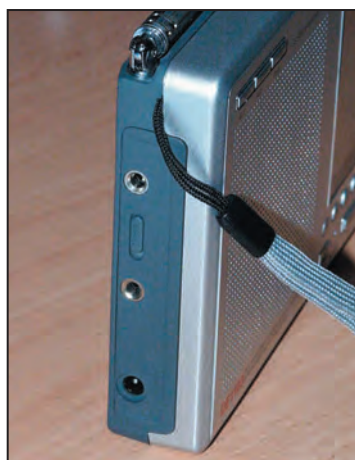
4 - Côté gauche : jack antenne, atténuateur, casque et alimentation.
